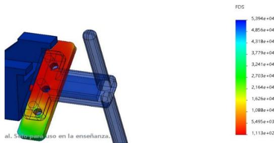
**Figura 24.** Diagrama de factor de seguridad del acople de la herramienta.
