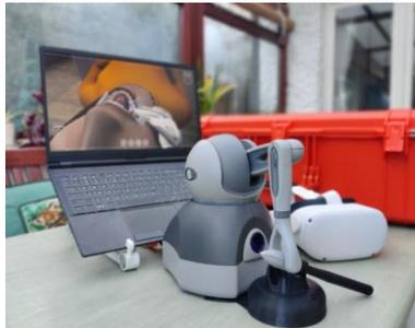
**Figura 10.** Simulador háptico UniSim [30].
