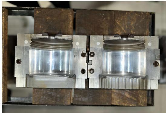
**Figura 2.** Molde de soplado en aluminio
