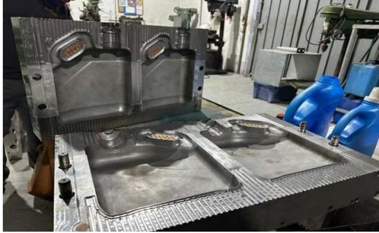
**Figura 1.** Molde de soplado en acero
