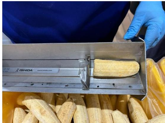
**Figura 34.** Prototipo para mediciones de longitud de plátano verde.
