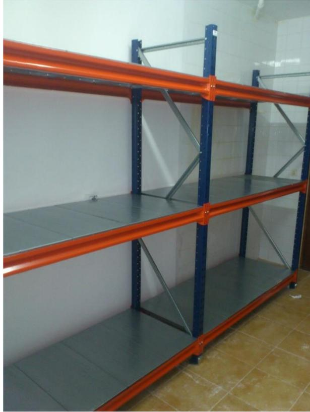
**Figura 28.** Diseño de estantería de bins de materia prima.
