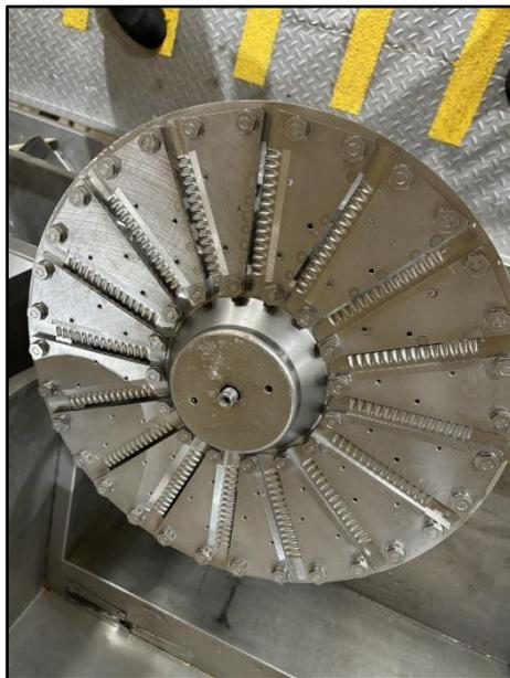
**Figura 12.** Cuchillas onduladas dentro del Rebanador.
