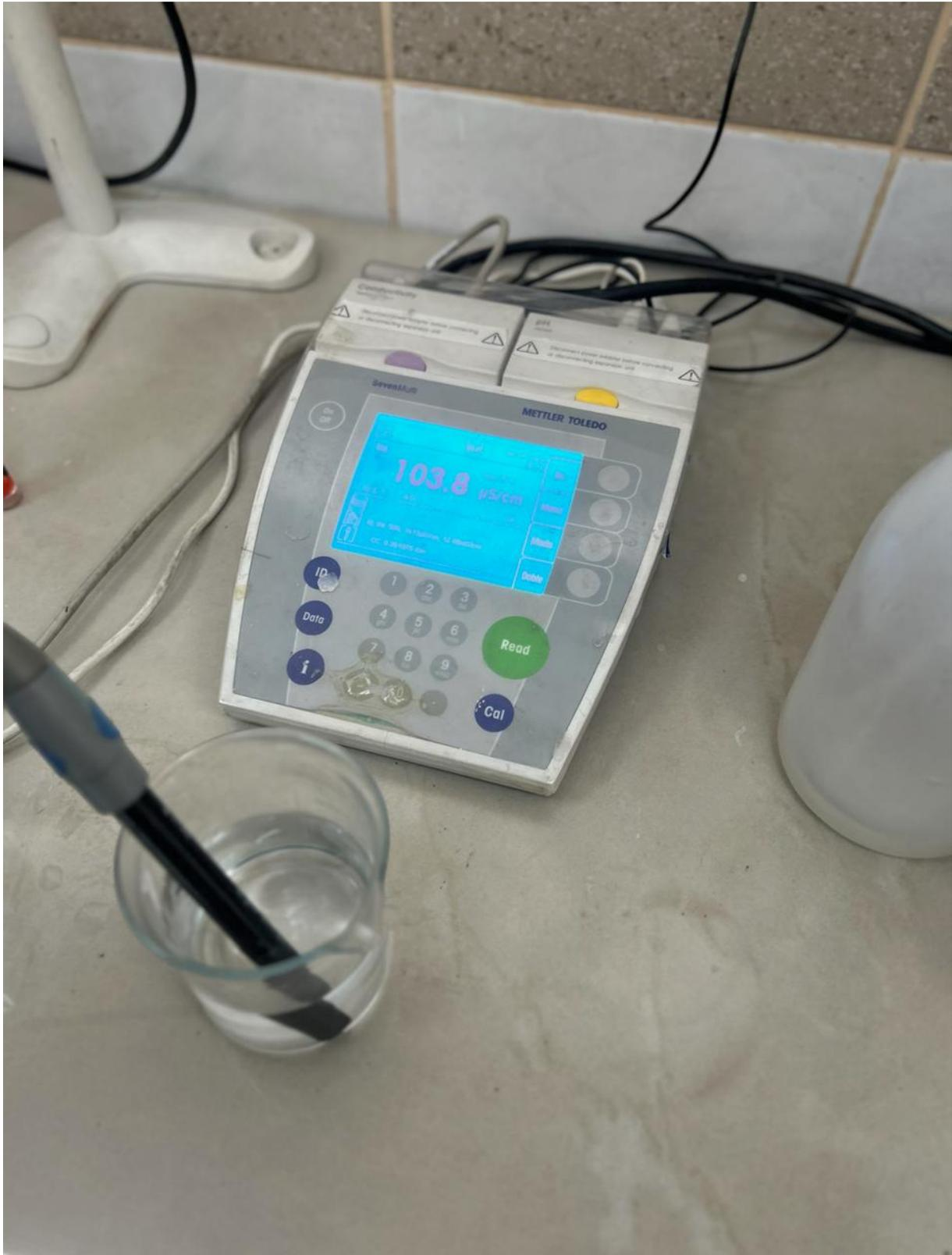
Figura 4.17: Medición de resistividad del agua Ensayo-Lluvia
