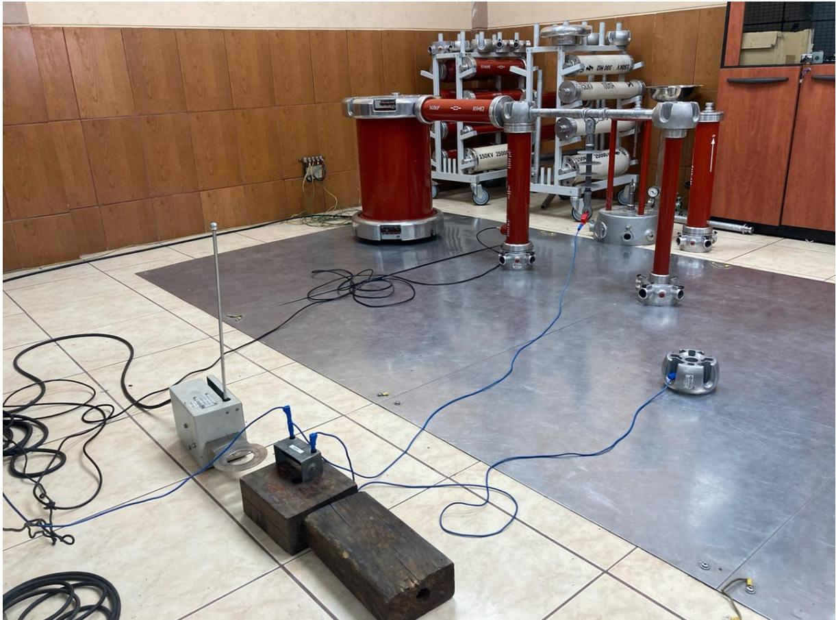
Figura 4.9: Polímero Ensayo-Seco
