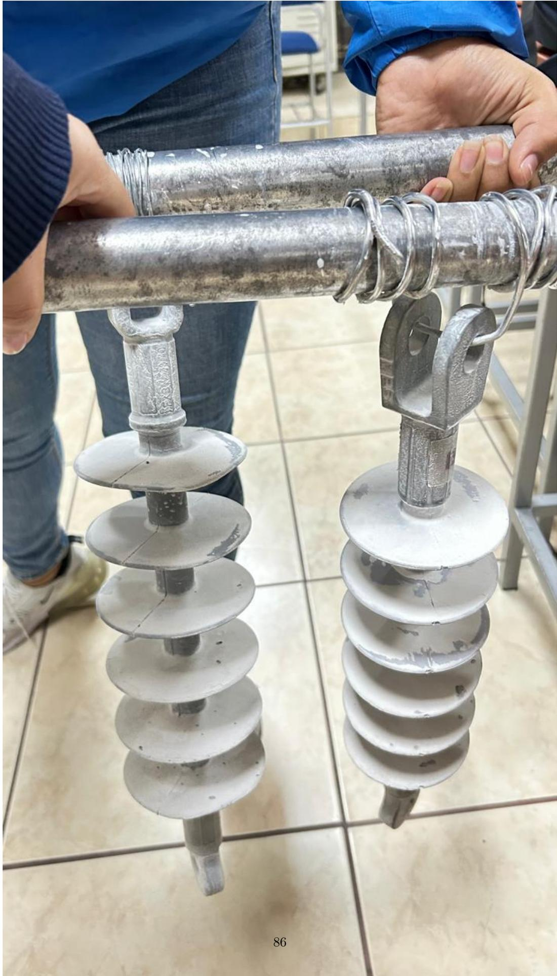
Figura 4.28: Polímeros Ensayo-Contaminación
