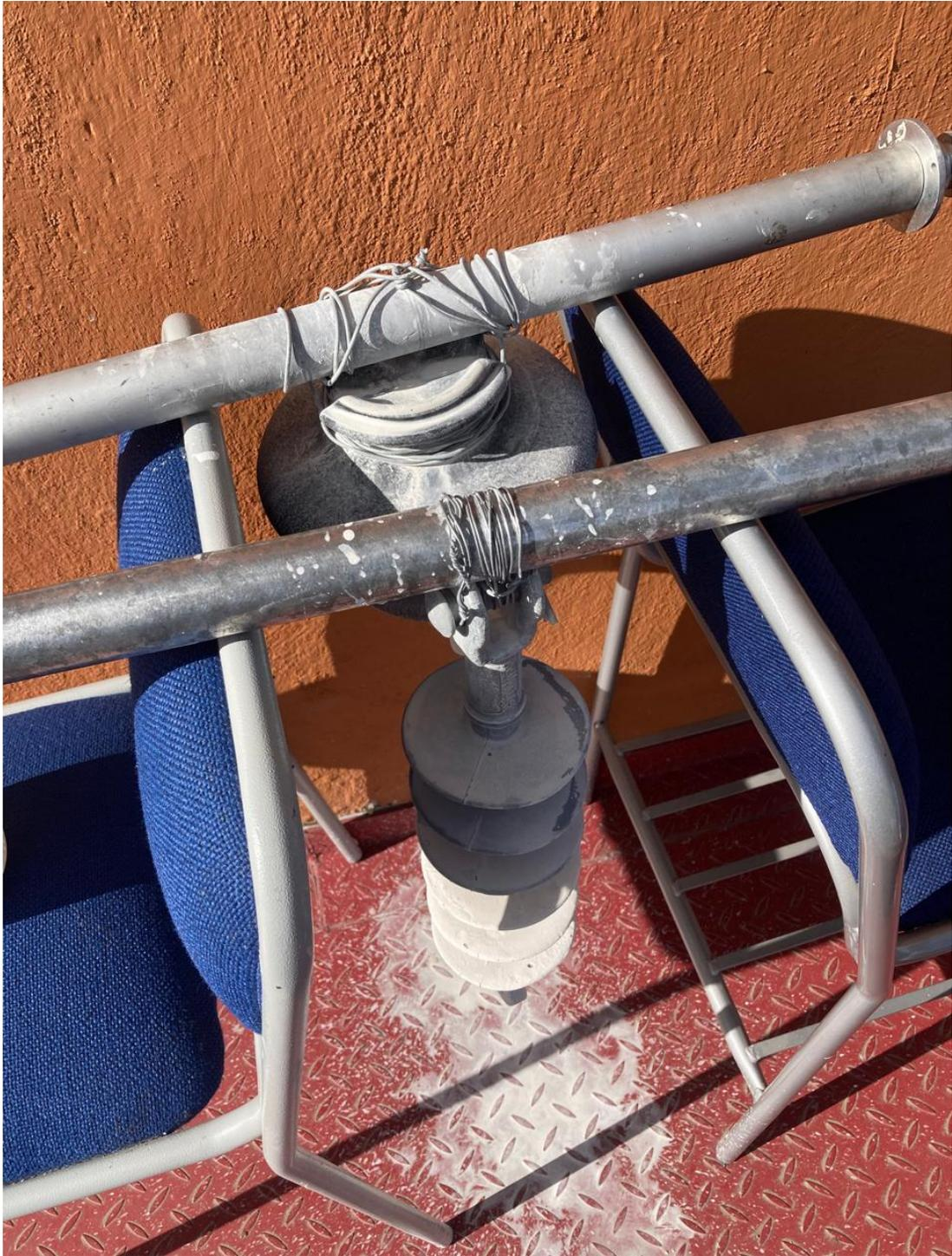
Figura 4.29: Secado de Polímero-Pin-Contaminación
