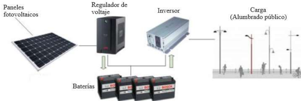
FIGURA 1.13: Sistema fotovoltaico autónomo [4]
