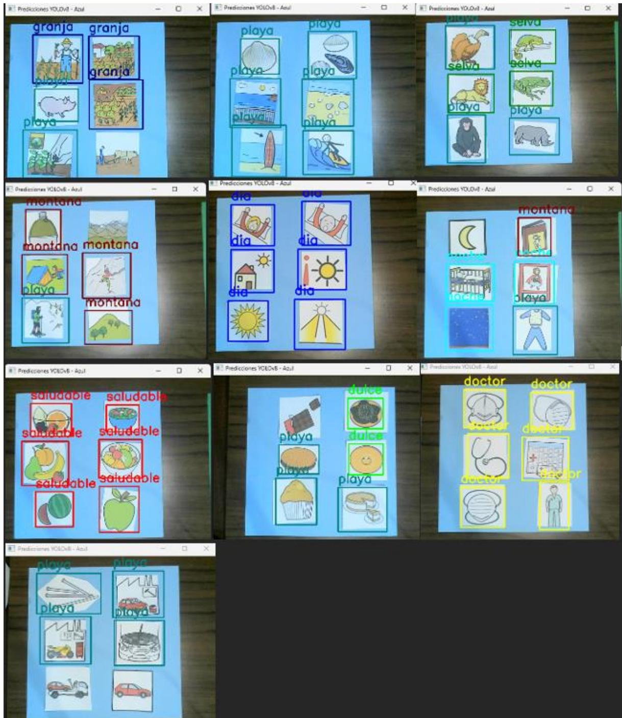
Ilustración 23 Ejemplo de predicciones en tiempo real.
