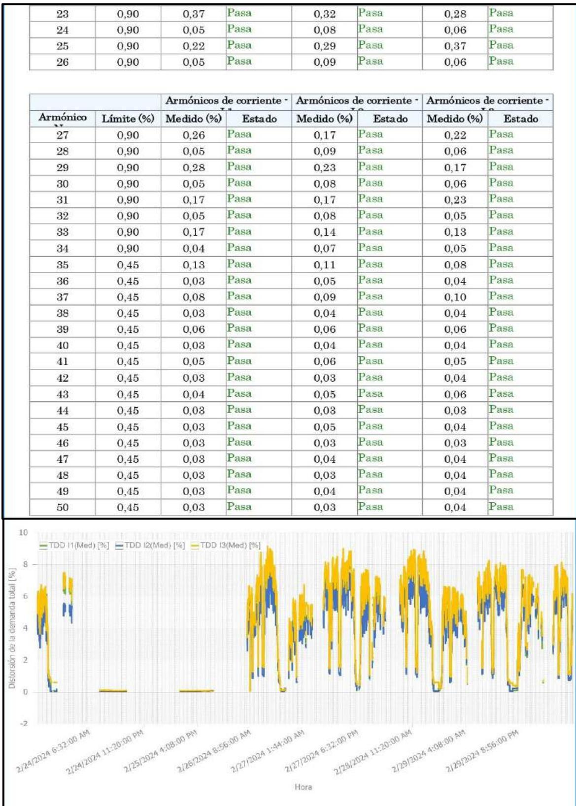
Figura No. 26. Tiempo corto Armónicos de corriente y TDD. 99%.
