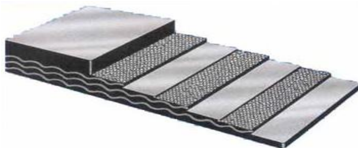
Figura 14.- Forma constructiva de la banda textil lisa Fuente: http://www.kauman.com/es/products/bt_lisas_es.asp
