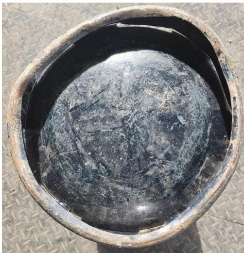
Figura 5. Base deformada por maltrato del cilindro en la envasadora CEM Lojagas [Fuente autor].
