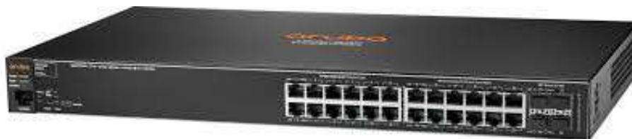
Figura 3.29: Switch de Acceso Aruba 2530 24G.
