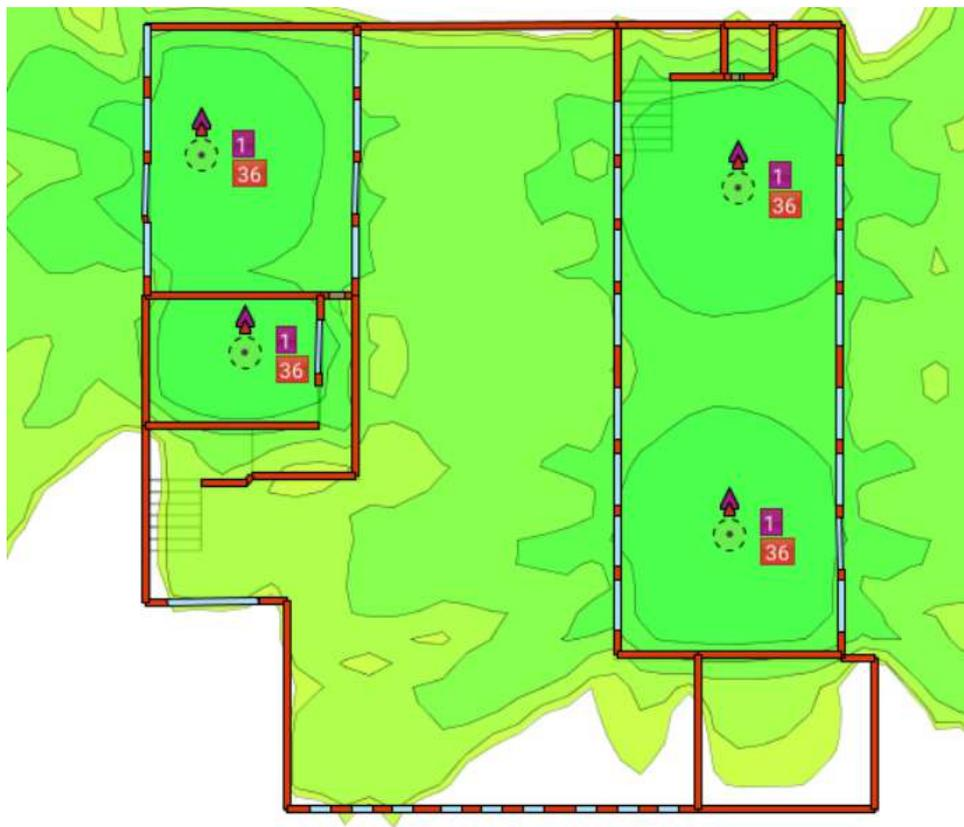
Figura 5.41: Simulación del área de cobertura en E2.
