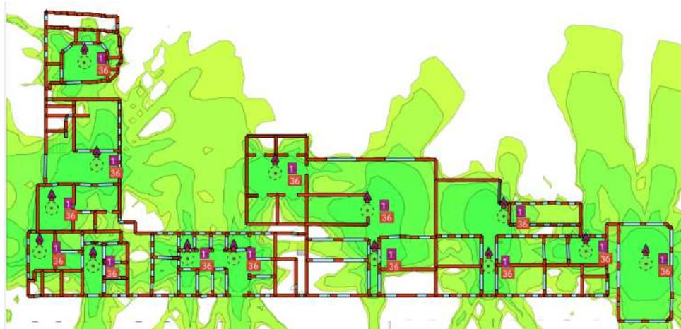
Figura 5.18: Simulación del área de cobertura en B1.
