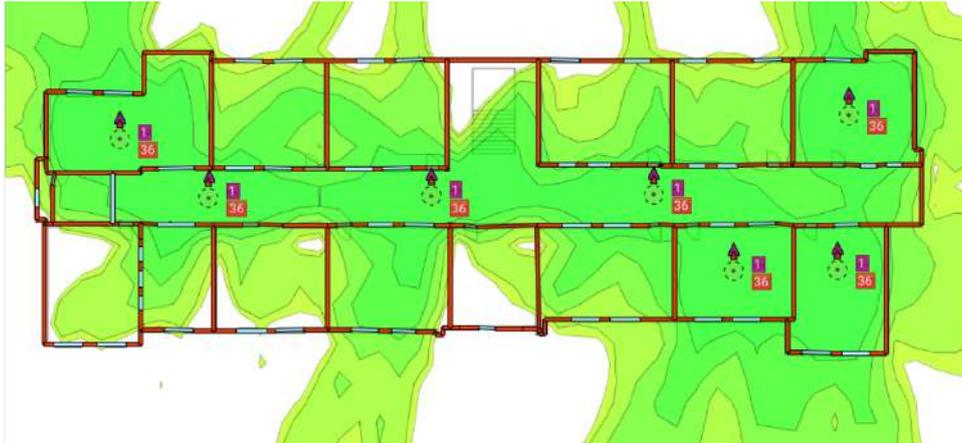
Figura 5.14: Simulación del área de cobertura en A4.
