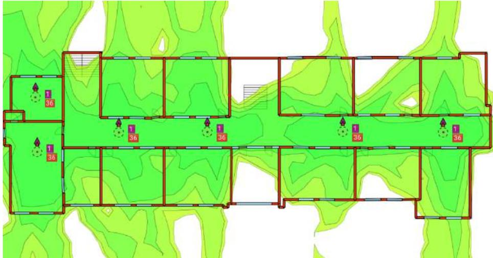
Figura 5.6: Simulación del área de cobertura en A2.
