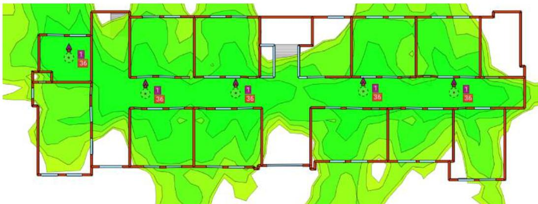
Figura 5.2: Simulación del área de cobertura en A1.
