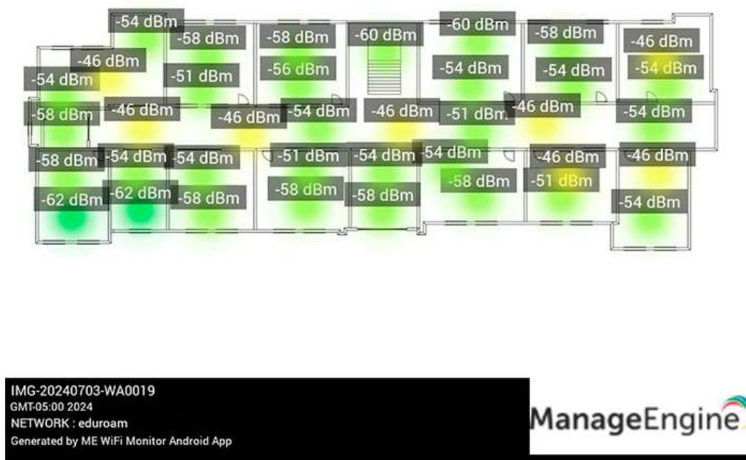
Figura 5.16: Resultado actual WiFi Analyzer en A4.
