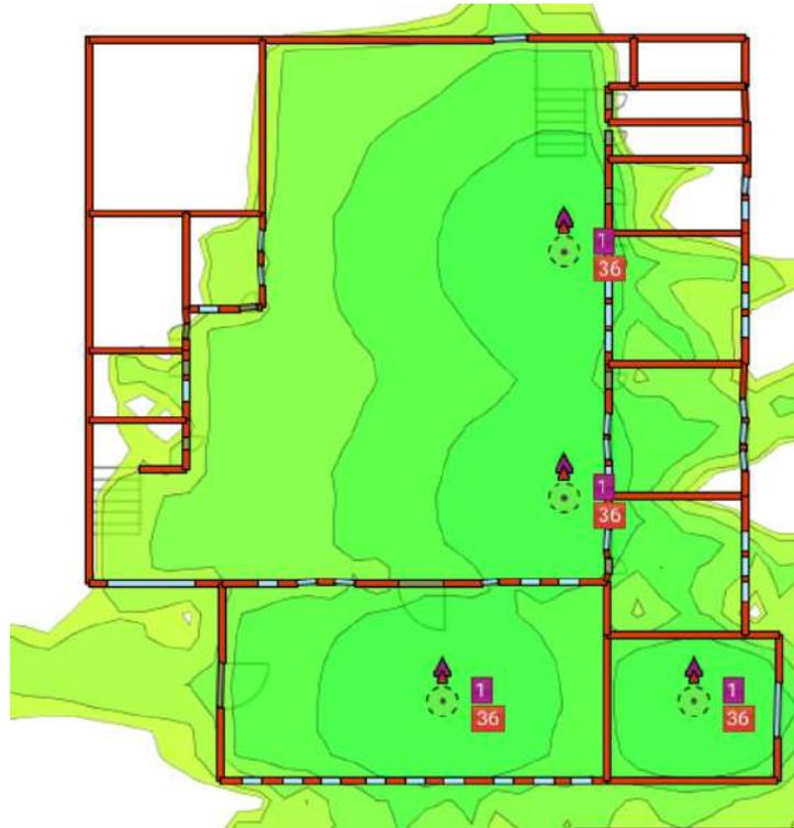
Figura 5.38: Simulación del área de cobertura en E1.
