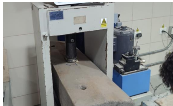
Figura 13. - Bordillo sobre apoyos con cuña de madera en la máquina de flexión
