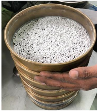
Figura 2. Tamizado del agregado artificial o “Polvo de Vidrio”
