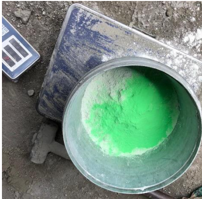
Figura 11. Mezcla en seco del pigmento.
