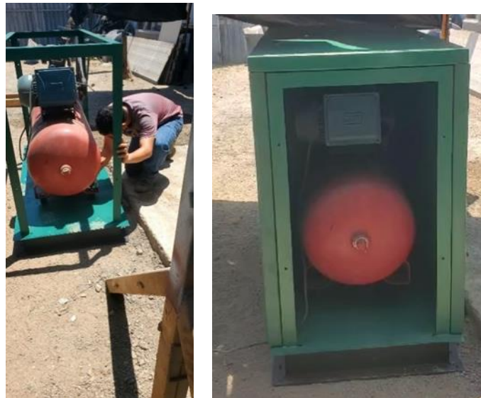
Ilustración 43: ubicación, ajuste, mediciones de temperatura y voltaje del compresor dentro de la cámara de insonorización.
