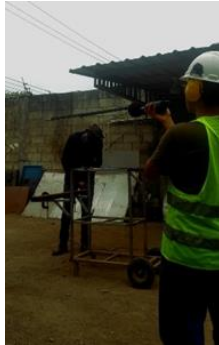
Ilustración 30: Medición de la actividad de corte con pulidora
