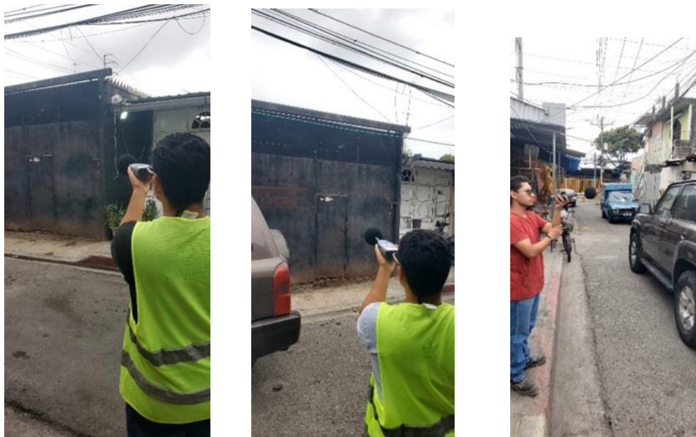
Ilustración 40: Mediciones de ruido fuera del taller antes de la implementación.
