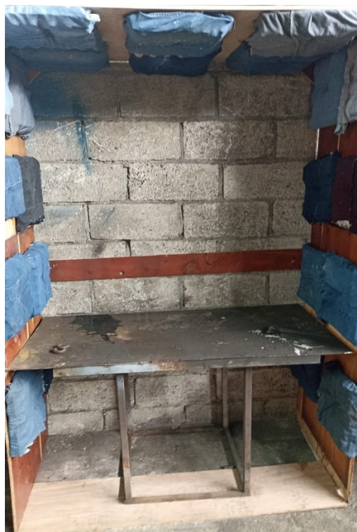
Ilustración 34 Instalación de la caja acústica con los paneles fonoabsorbentes
