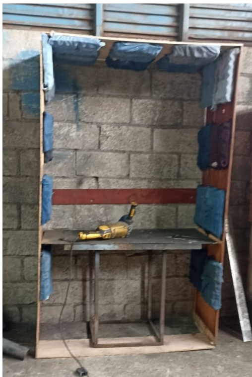
Ilustración 34 Instalación de la caja acústica con los paneles fonoabsorbentes
