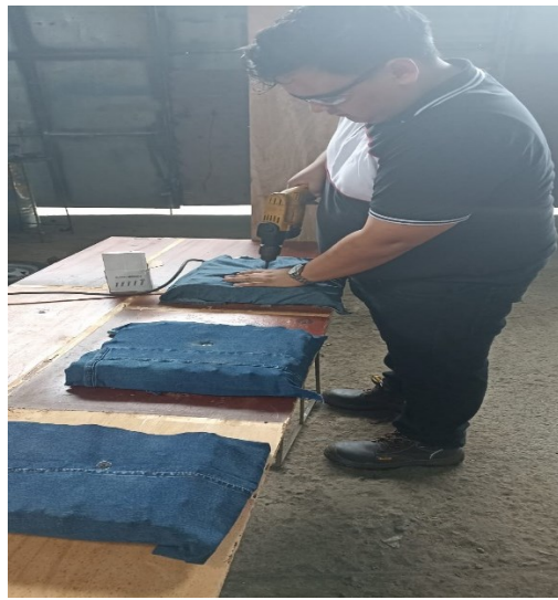
Ilustración 33 Implementación de los paneles fonoabsorbentes en la caja acústica
