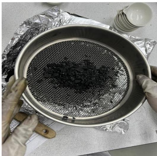
**Figura 9** Tamizado del carbón obtenido a base del endocarpio del coco con tamiz de 2,36 mm
