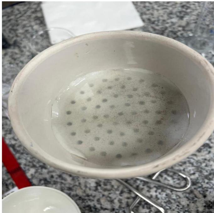
**Figura 18** Filtración de agua por papel filtro
