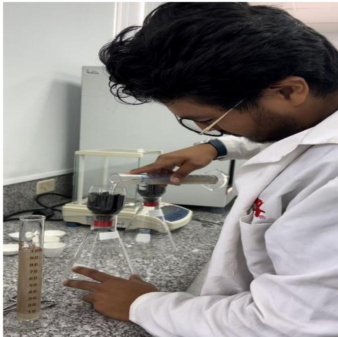
**Figura 20** Filtración de agua por el carbón activado obtenido a base del endocarpio del coco
