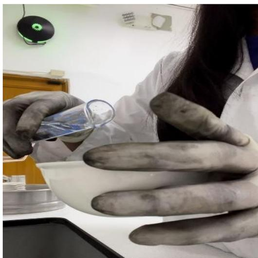
**Figura 10** Activación del carbón obtenido a base del endocarpio de coco
