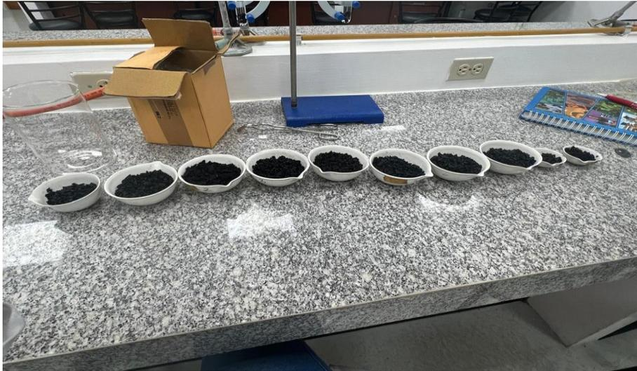
**Figura 15** Carbón activado a base del endocarpio de coco en cápsulas de porcelana
