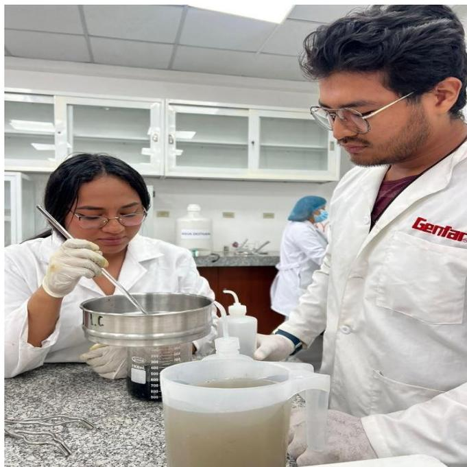
**Figura 12** limpieza del carbón obtenido a base del endocarpio del coco con agua destilada
