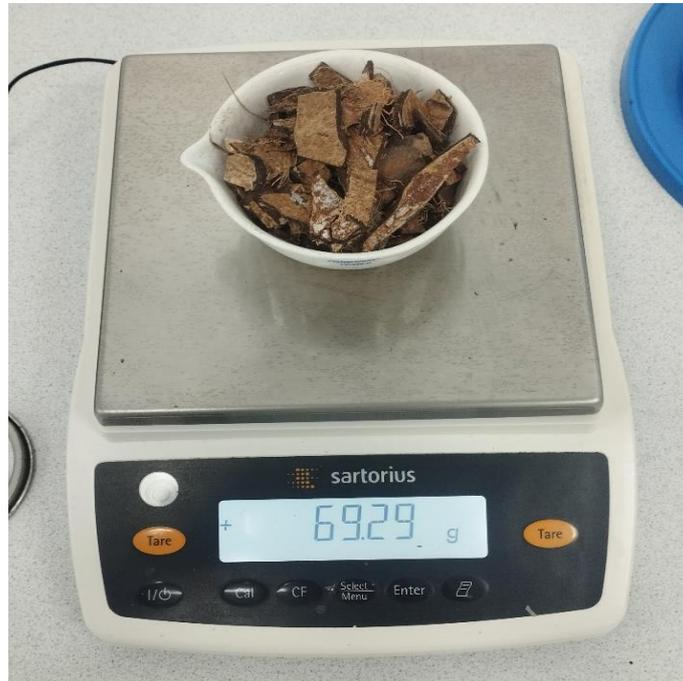
**Figura 11** Pesaje del endocarpio del coco en balanza
