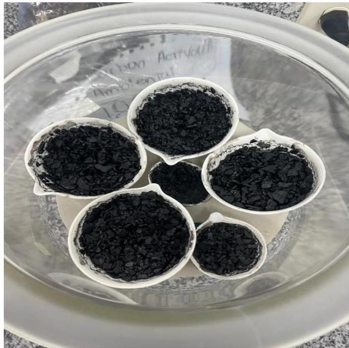
**Figura 16** Carbón activado en el desecador
