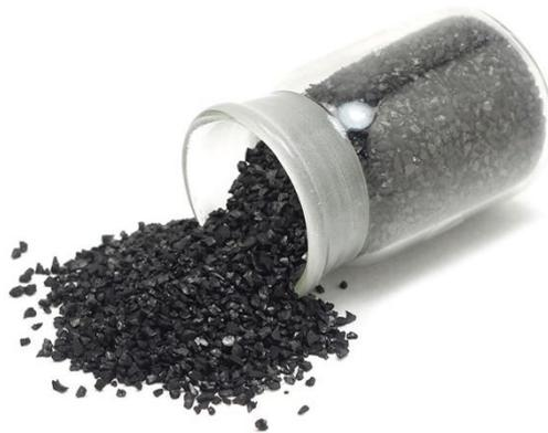
**Figura 4** Carbón activado granular
