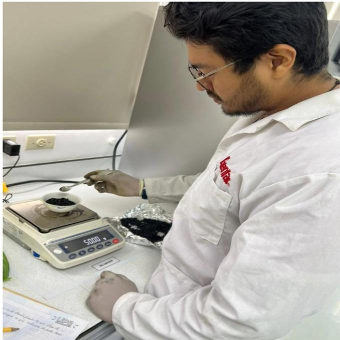
**Figura 14** Pesaje del carbón a base del endocarpio del coco en balanza
