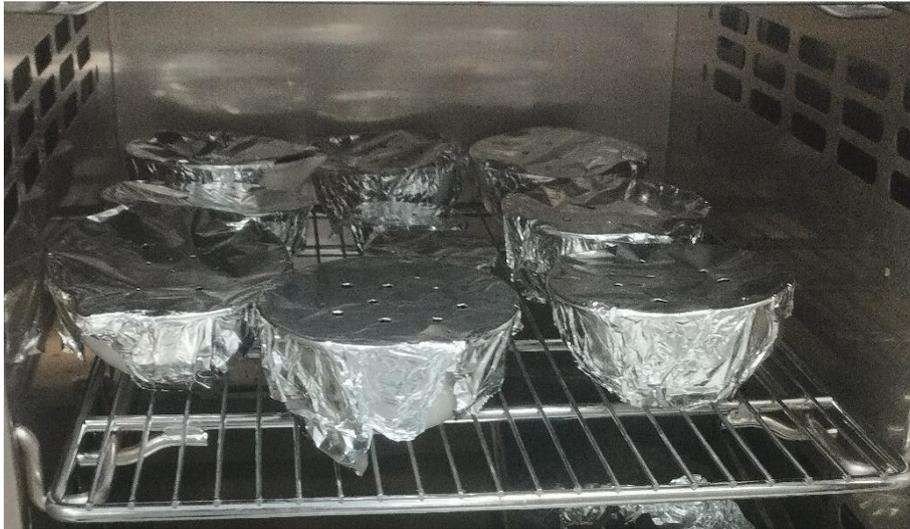
**Figura 13** Secado del carbón activado obtenido del endocarpio del coco después de su limpieza en una estufa a 120 °C
