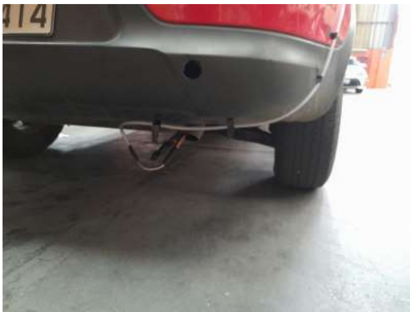
Figura 62 Sonda del analizador de gases.
