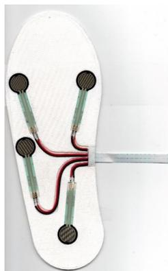
**Figura 20.** Sensor de posicionado en 4 puntos del pie.
