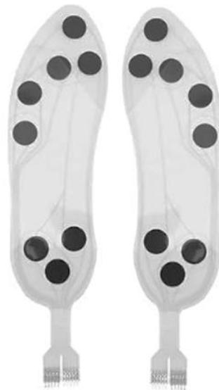
**Figura 21.** Sensor de posicionado en 8 puntos del pie [21].
