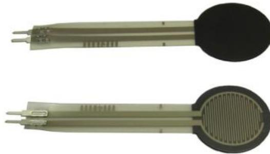
**Figura 23.** Sensores de fuerza o presión FSR 402 [18].
