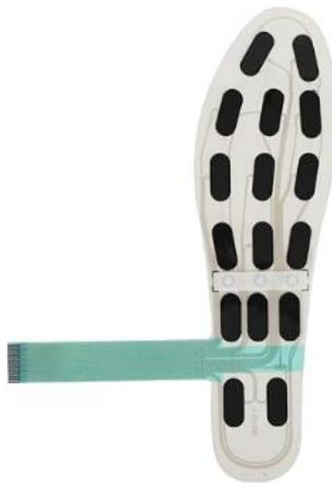
**Figura 22.** Sensor de posicionado en 16 puntos del pie [22].
