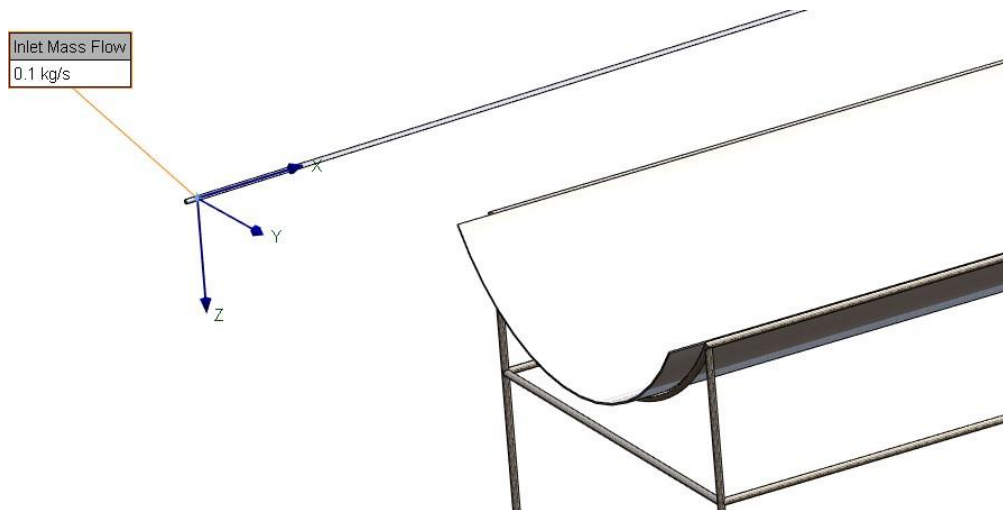
Figura 23. Definición de flujo másico del agua.
