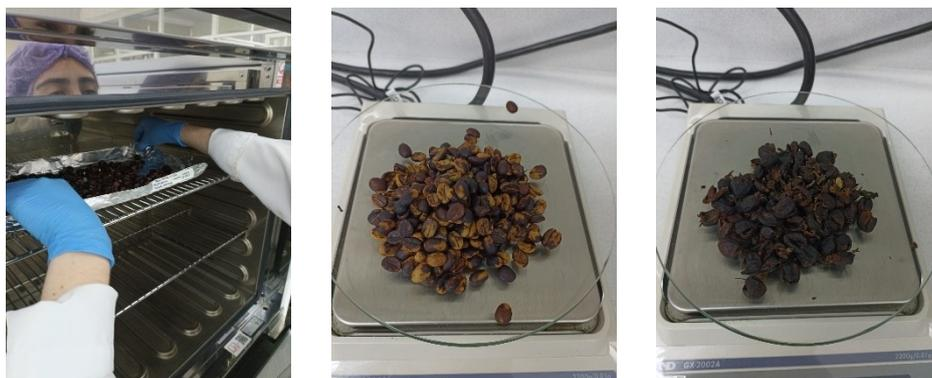
*Nota: Tras el secado, las muestras se preparan para el proceso de molienda y tamizado, asegurando que estén en óptimas condiciones para su análisis.*
