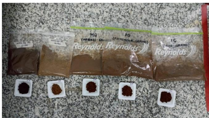
*Nota: Se pesan 0.5g de cada muestra molida y tamizada para su posterior digestión asistida por microondas.*
