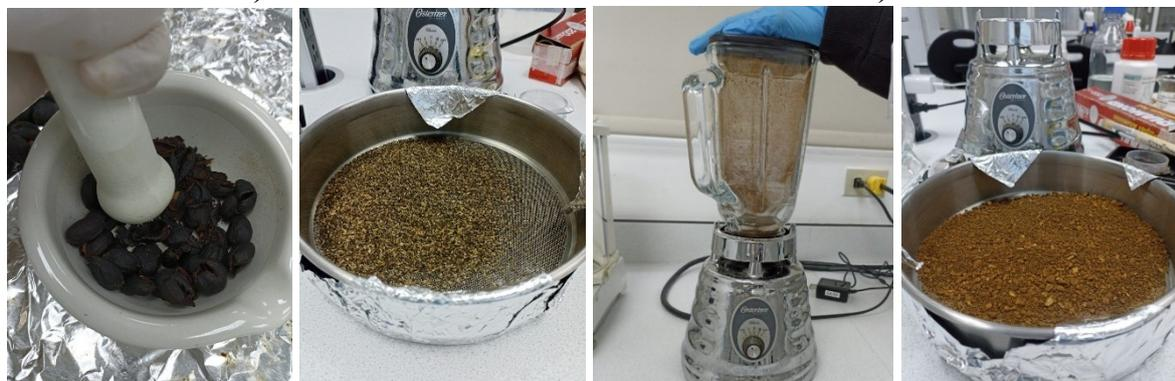
*Nota: a) Las cáscaras secas se muelen en un mortero y luego se tamizan cuidadosamente ; b) Los granos secos se muelen en una licuadora y se tamizan para obtener un tamaño uniforme de las partículas.*
