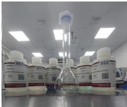
*Nota: Estandar multielemental para calibración de curva en ICP-OES*
