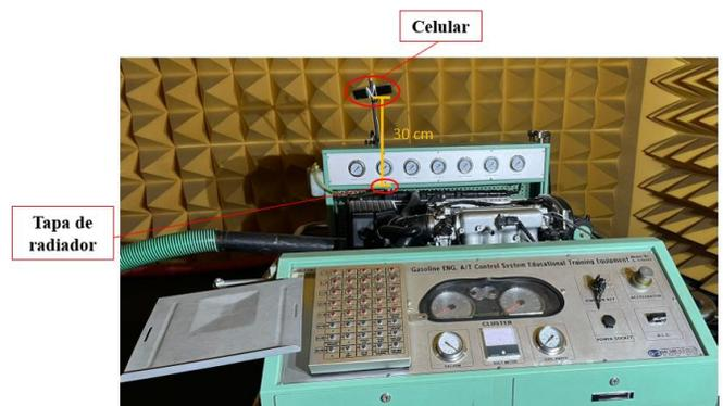
Figura 6. Instrumentación para toma de muestras.
