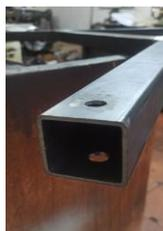
**Figura 7.** Acero estructural A36 50x50mm.
