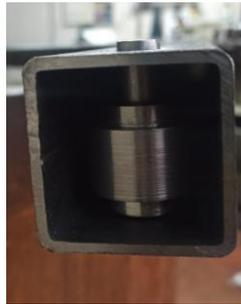
**Figura 60.** Instalación de las poleas dentro de la estructura.
