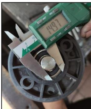
**Figura 29.** Diámetro interno del rodamiento del eje.
