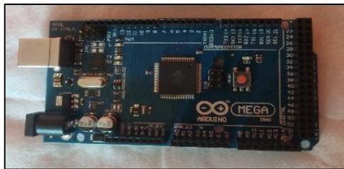
**Figura 13.** Microcontroladores Arduino MEGA.
