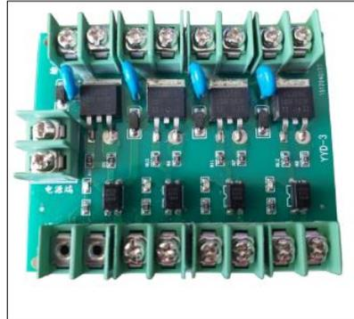
Figura 36. Tarjeta para el control de los motores.
