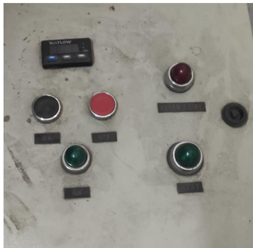
Fig.14. Sistema de control actual del horno.
