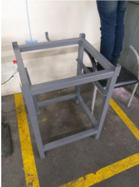
Fig.27. Mesa de soporte del horno instalada en su lugar de trabajo.
