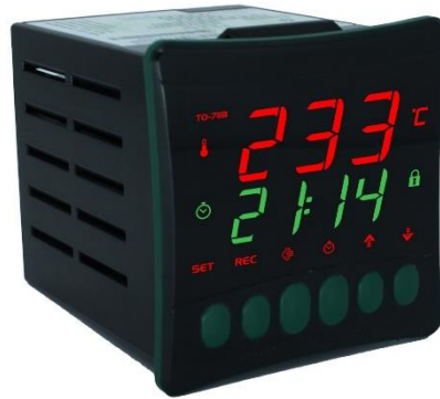
Fig.7. Control de temperatura [10].
