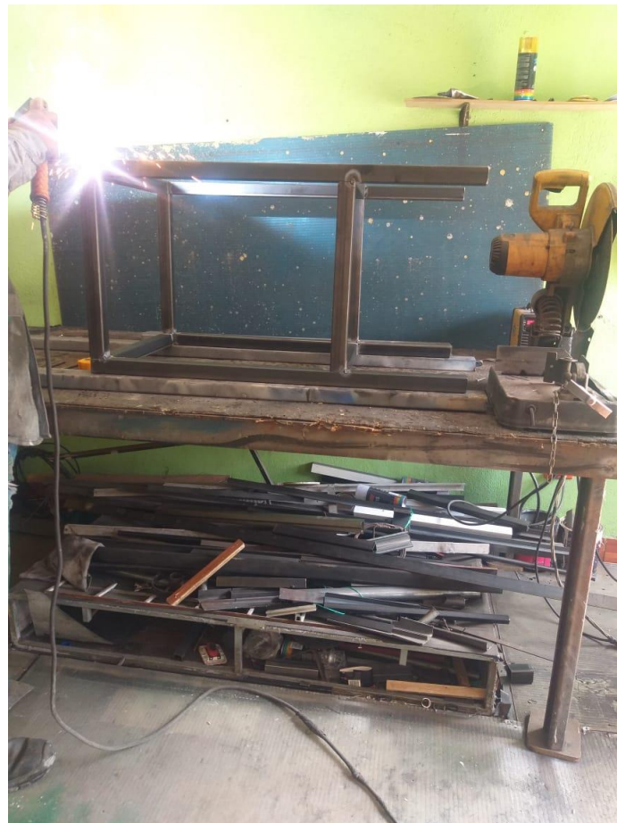
Fig.24. Elaboración de puntos de suelda en la estructura.
