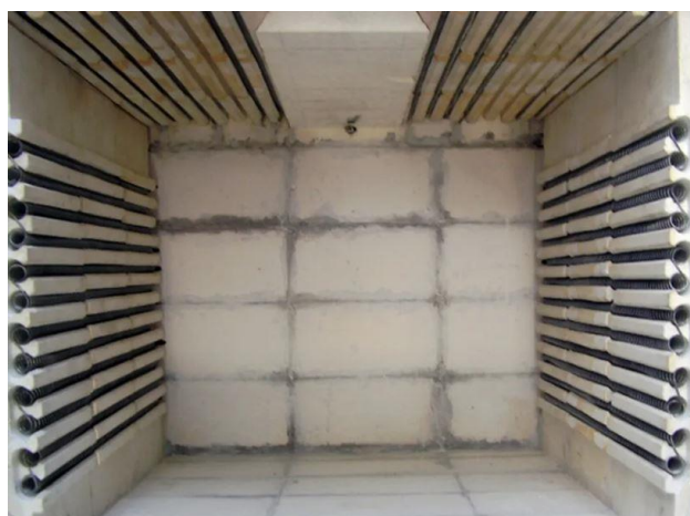
Fig.20. Resistencias de tipo espiral que utiliza el horno.
