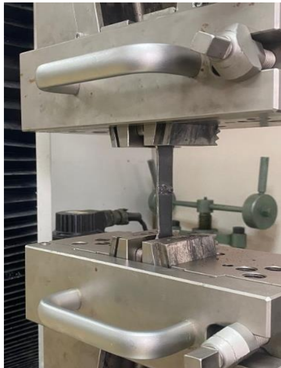
Figura 25. Puesta en máquina del espécimen
