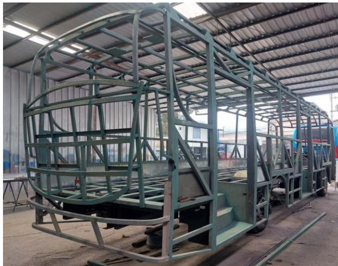
Figura 5. Estructura de un bus urbano tipo G8
