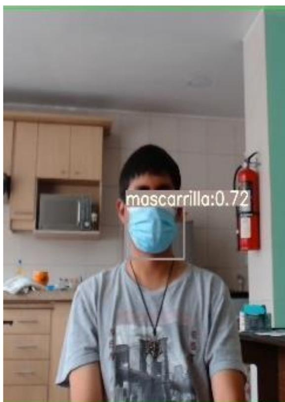
Figura 4.1 Detección de mascarilla a 2 metros de distancia
