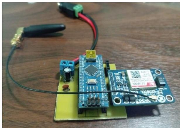
Figura 3.9 Elementos soldados en la PCB
