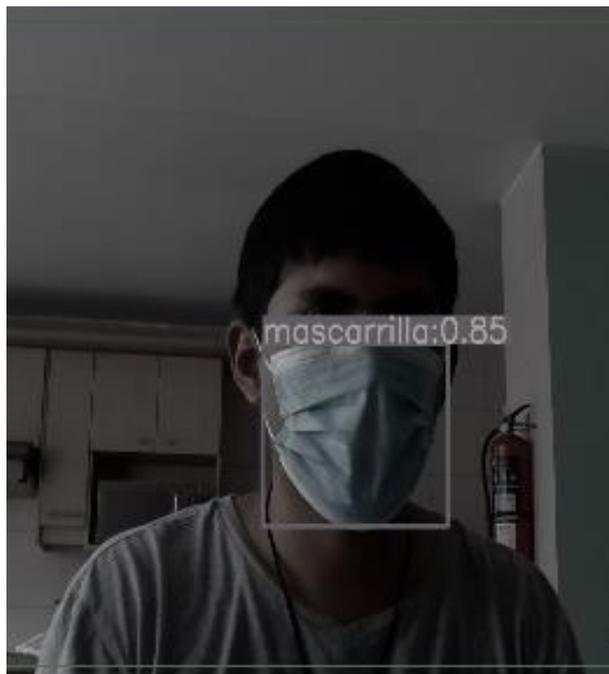
Figura 4.3 Detección de mascarilla a 1 metros de distancia
