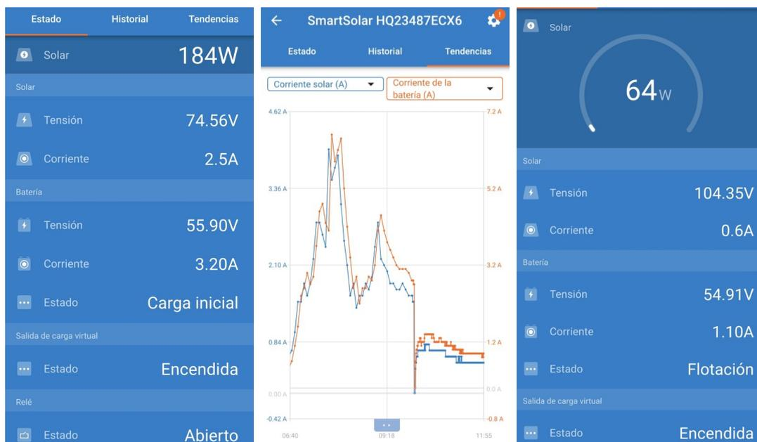
**Figura 3.16:** Potencia, voltaje, corriente del sistema y estado de carga del banco de baterías en el día 1 y el día 3.
