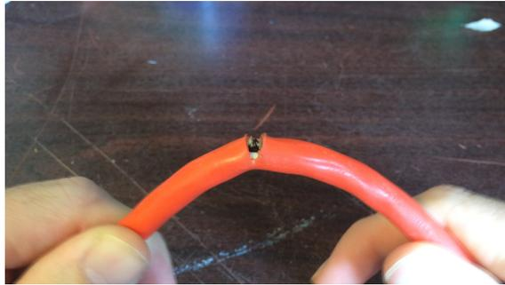
**Figura 4.13:** Cable con daños en su aislamiento por corte
