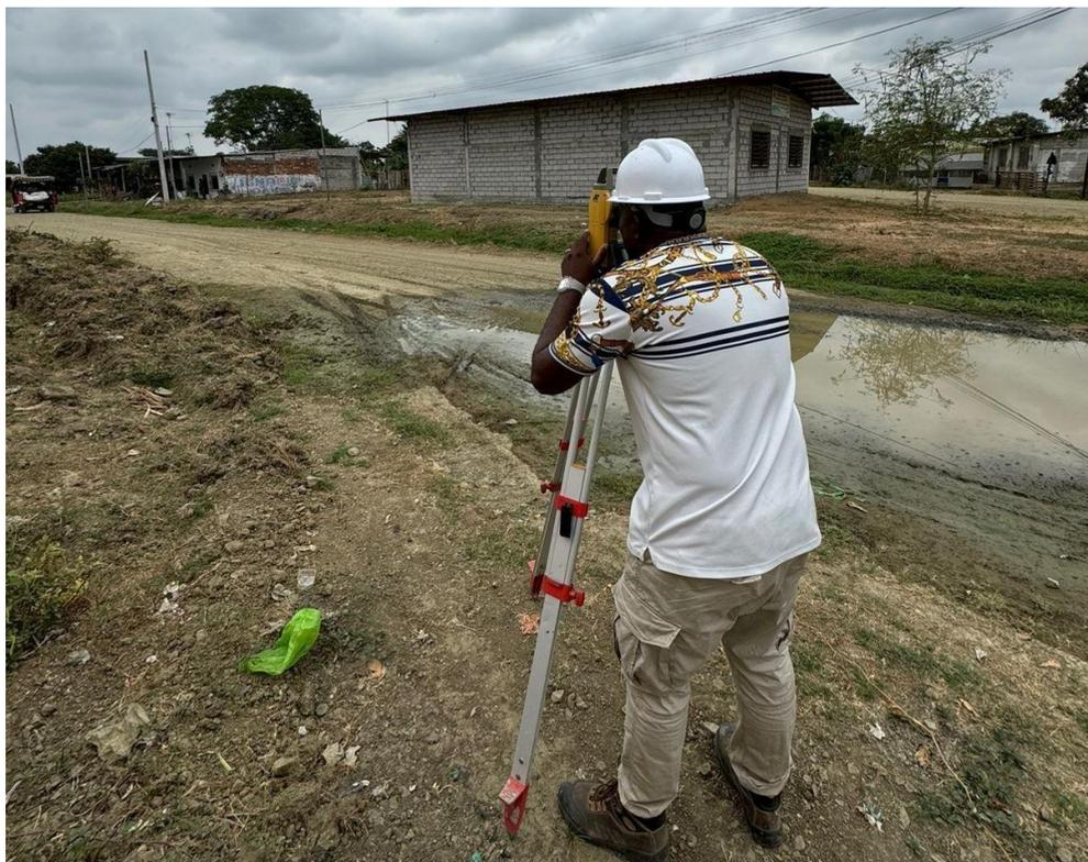
**Imagen 31 Medición del Terreno con Estación Total**
