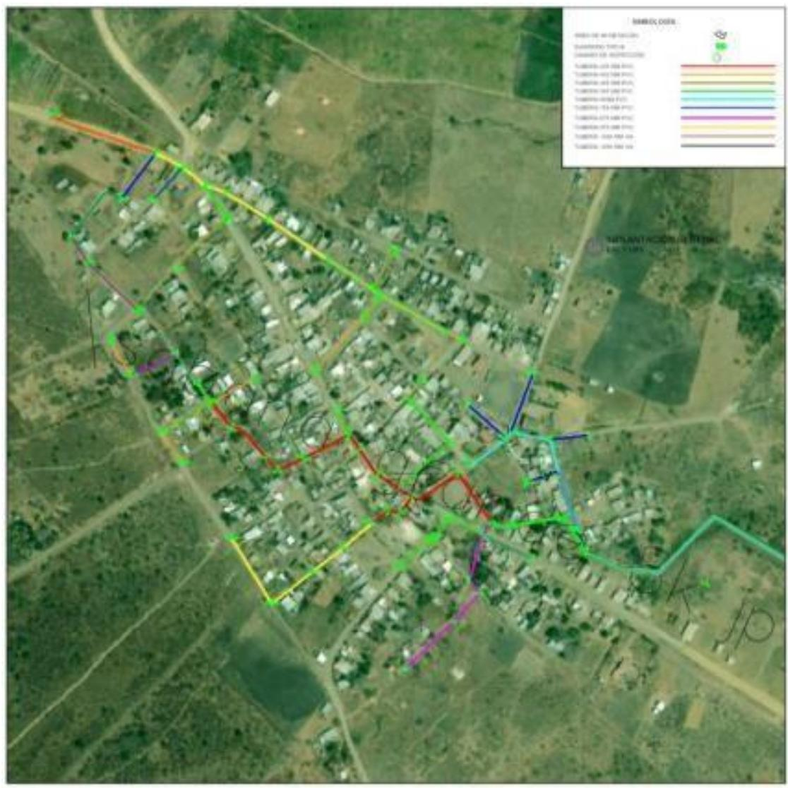
**Imagen 15 Referencia de Red de Colectores y Canales**
