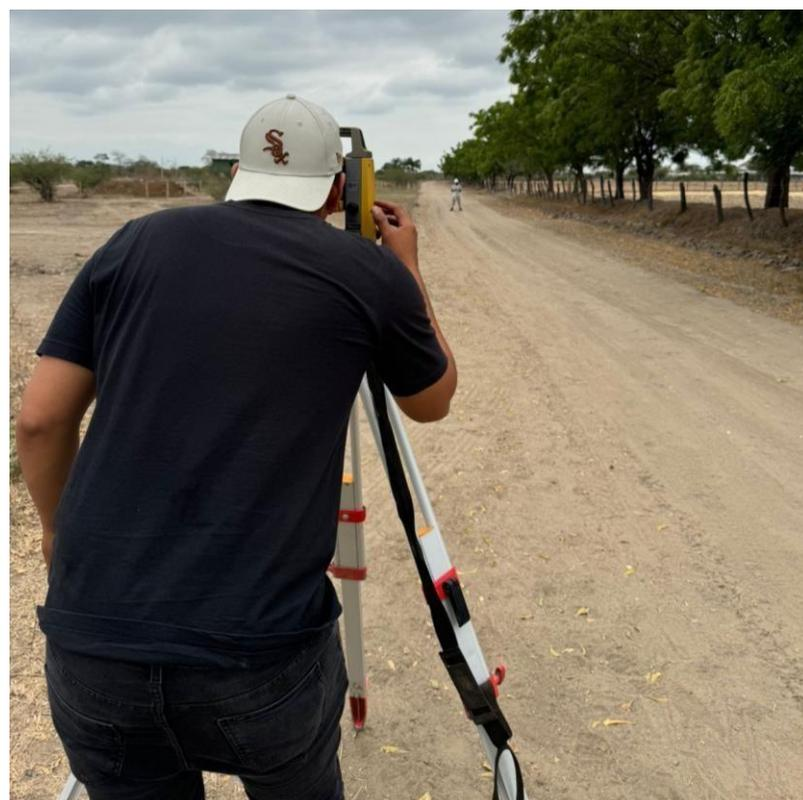
**Imagen 29 Medición de los puntos Topográficos**
