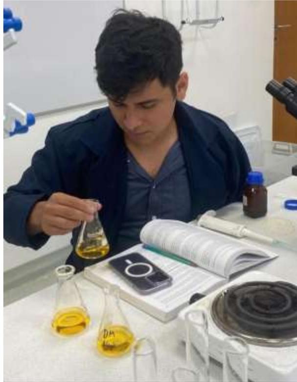
*Ilustración 26. Medición de alcalinidad*
