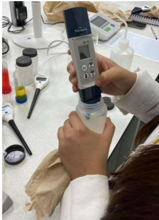
*Ilustración 27. Medición de solidos disueltos totales*
