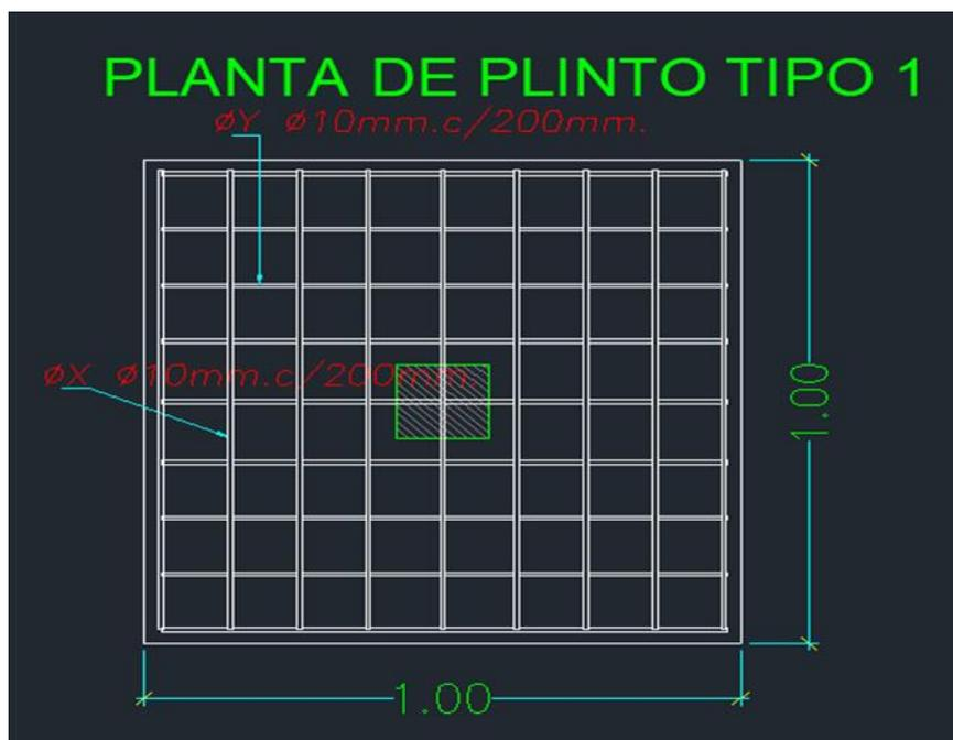
**Figura 25.- Zapata aislada tipo 1 modelado en Revit. (Autor)**
