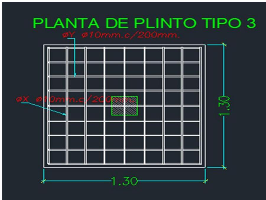
**Figura 29.- Zapata aislada tipo 3 modelado en REVIT. (Autor)**
