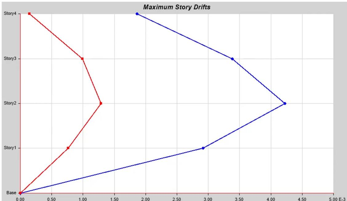
En la ilustración 59 se muestra la máxima deriva correspondiente al sismo estático en Y. El valor es  $\text{Drift} = 0,003676$ , se lo reemplaza en la siguiente ecuación para obtener la deriva inelástica que debe ser menor que el 2%.
