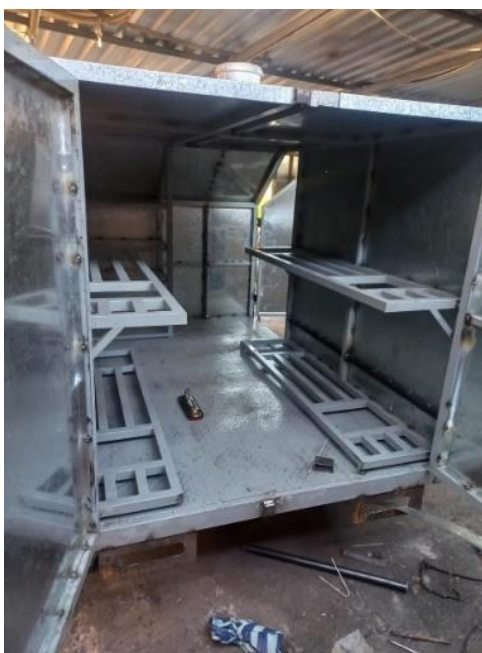
Figura 51.- Terminado de recubrimientos y elementos auxiliares
