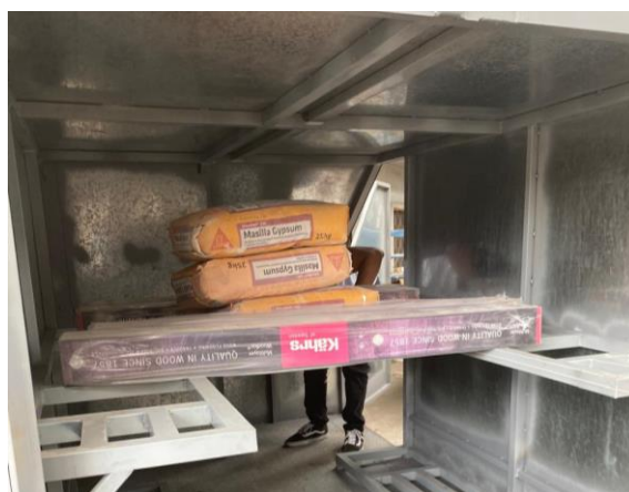
Figura 64.-Cargas aplicadas en la estructura
