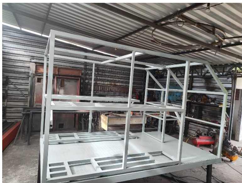
Figura 49.- Estructura interna terminada del remolque
