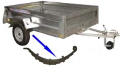
Figura 4.- Remolque con suspensión de tipo ballesta
