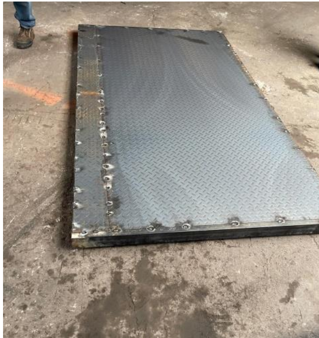
Figura 46.- Piso de la estructura del remolque
