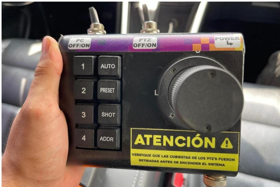
**FIGURA 23.** Mando para encender el CPU, la cámara termográfica, de efecto corona y para interactuar con las cámaras
