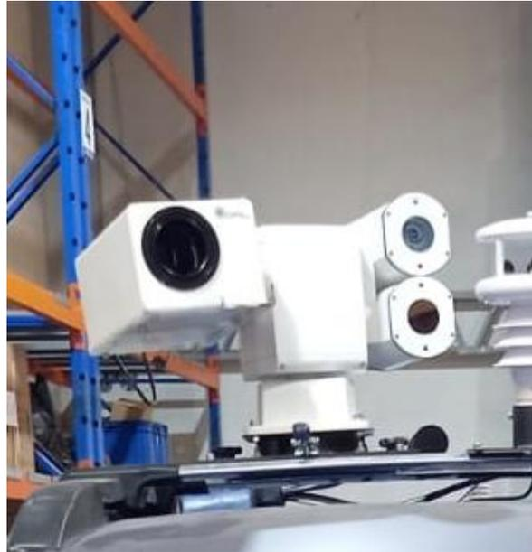
**FIGURA 6.** Cámara de efecto corona y RGB usada en el recorrido
