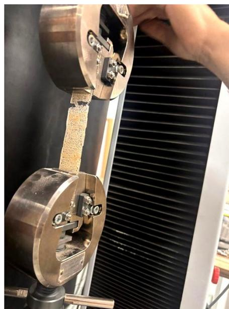
**Figura 12.** Visualización de la rotura de la probeta.
