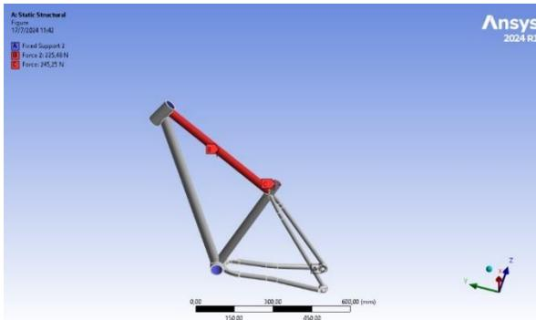
**Figura 15:** Con una calidad del mallado de 0,98. Se aplica la fuerza de 245,25N y una fuerza en el parante AD simulando la carga que soporta el cuadro
