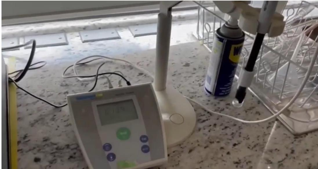
*Anexo 10 Equipo utilizado para medir el pH de las muestras y realizar la caracterización fenotípica*
