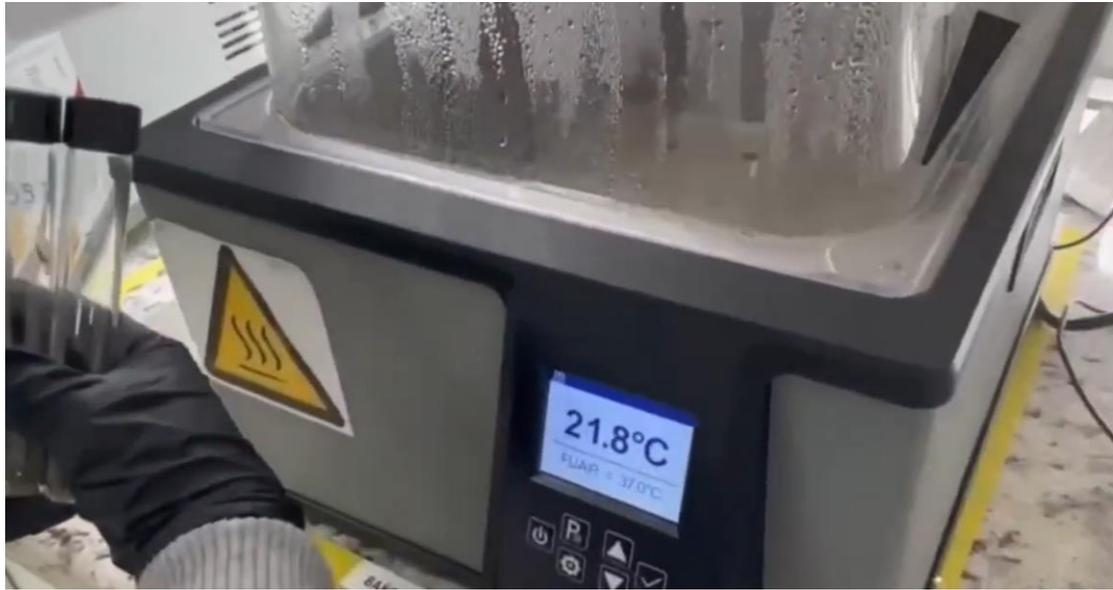
*Anexo 11 Equipo utilizado para ajustar la temperatura establecida a cada muestra para la caracterización fenotípica*
