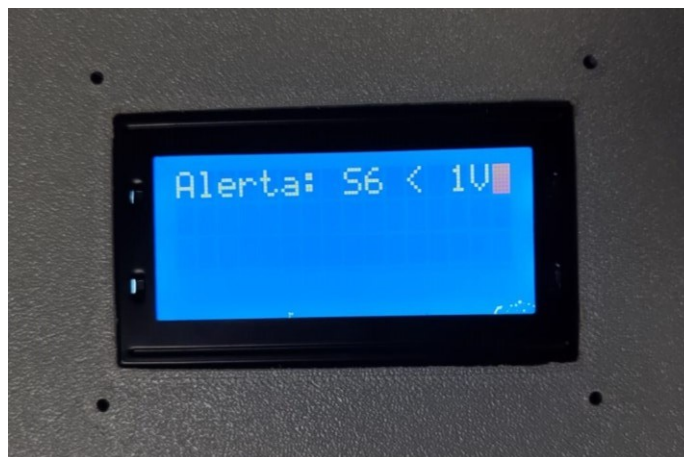
Figura 67. Pantalla LCD mostrando alerta de bajo voltaje en celda específica del banco de monitoreo.
