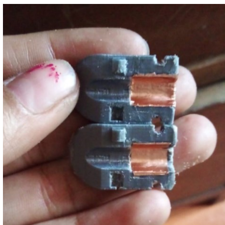
Figura 72. Pinzas de sujeción para terminales de baterías.
