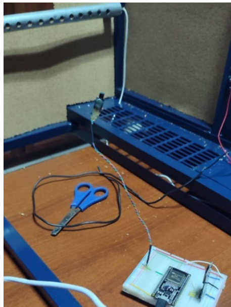
Figura 73. Calibración del PID: Sensor de temperatura en el banco de monitoreo.
