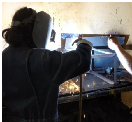
Figura 60. Elaboración de puntos y cordones de sueldas en la estructura.
