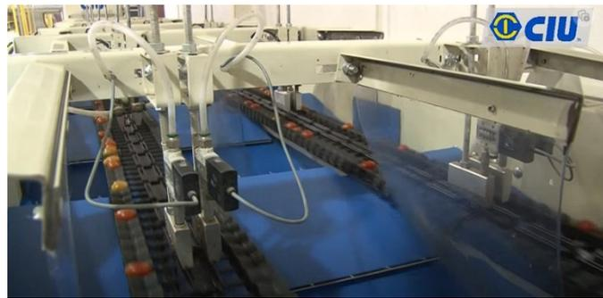
**Figura 5.** Clasificación por visión artificial [21].
