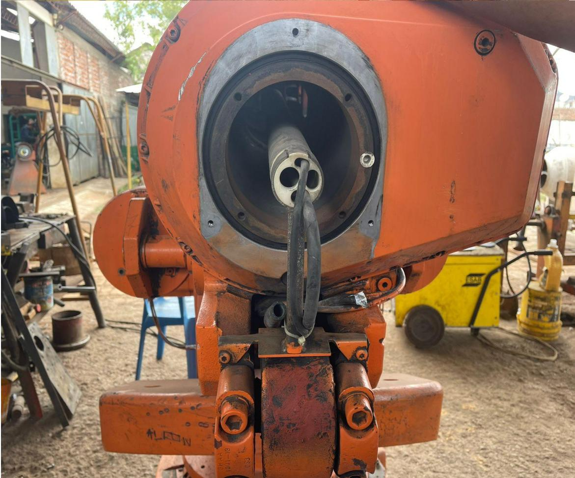
En esta sección el cable está cortado lo que impide la comunicación entre en el robot y el control, aproximadamente son 60 hilos. Es uno de los inconvenientes de no poder utilizarlo ya que se tardaría mucho tiempo en encontrar el hilo correspondiente, por ello se dio por utilizar una nueva lógica de conexión
