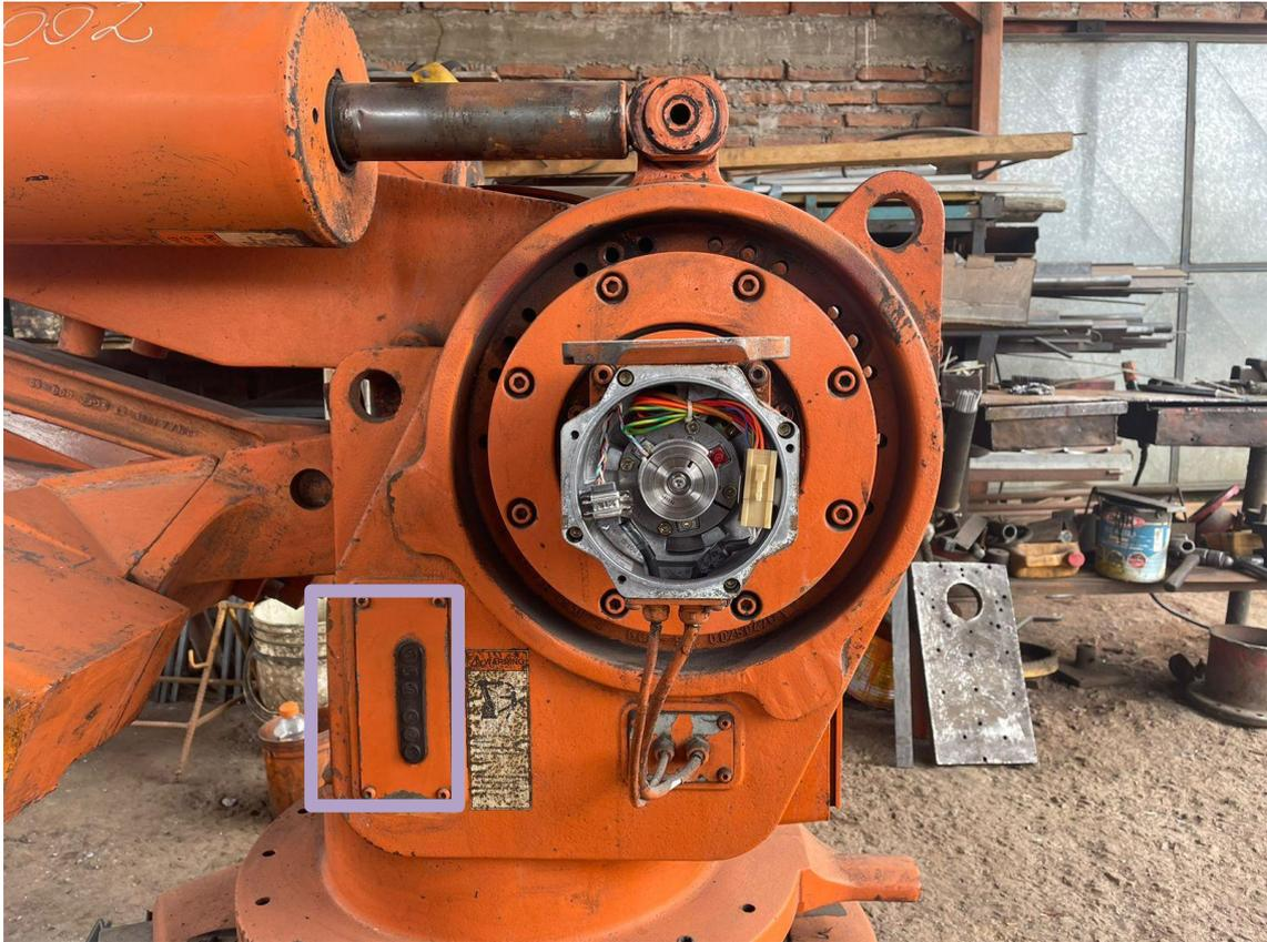
Mediante esta botonera se pudo levantar, pero por la falla de los cables cortados no permite bajarle nuevamente
