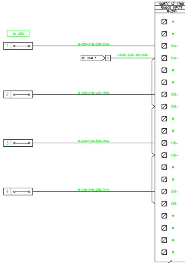
**Figura 15** Conexión de entradas analógicas 6ES7531-7NF1 AI-200.
