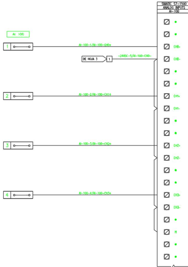
**Figura 14** Conexión de entradas analógicas 6ES7531-7NF1 AI-100.
