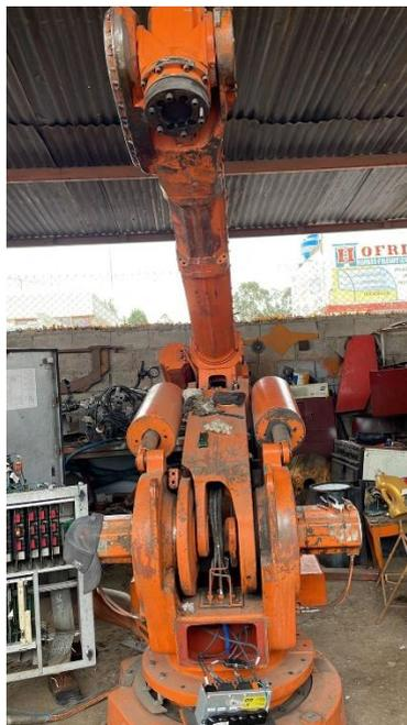
A excepción de esos cortes de los cables la estructura interna de igual forma el cableado está en buenas condiciones esto se ve en los anexos
