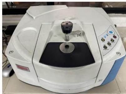
*Nota:* Equipo utilizado para realizar el análisis espectral mediante Fourier Transformed Infrared (FTIR) junto con el software de espectroscopia “OMNIC spectra” potente con una base de datos integral y herramientas de búsqueda avanzadas.
