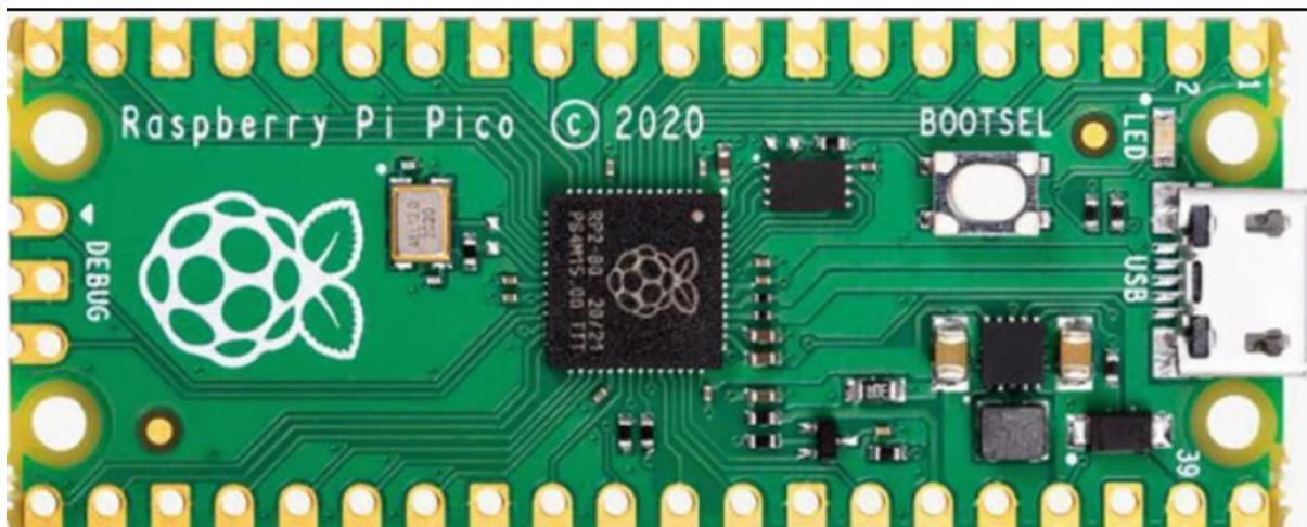
Figura 1.1: Vista superior de la placa Raspberry Pico
