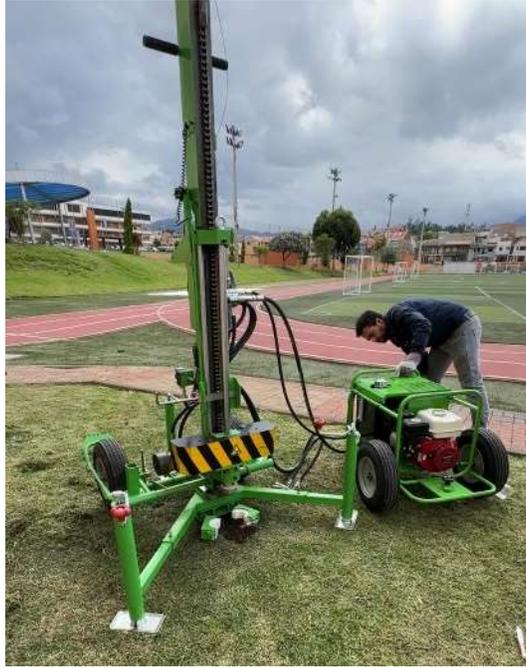
**Figura 23** Máquina para ensayo SPT de la UPS
