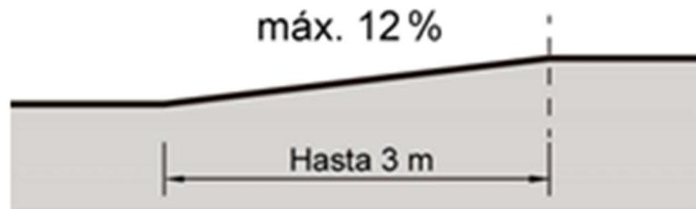
**Figura 4** Pendientes en construcciones existentes
