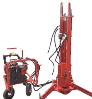
**Figura 17** Máquina ensayo SPT
