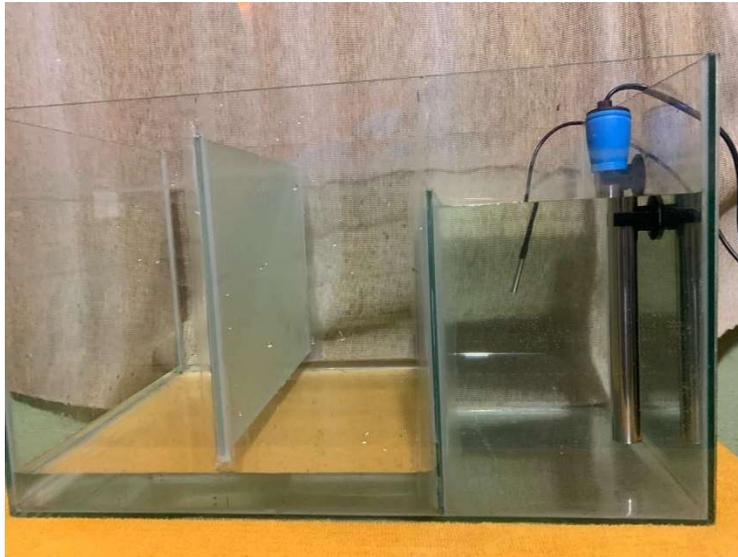
**Nota:** La figura 47 muestra la implementación de la resistencia calorífica en el sump.
