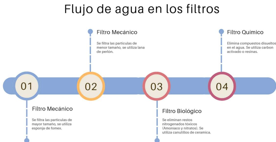
**Nota:** Se puede observar en esta figura el flujo que sigue el agua en los filtros ubicados en el sump.
