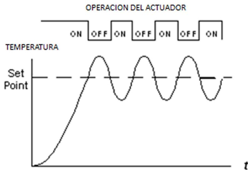
**Nota:** La figura 10, se presenta el comportamiento de un sistema de control on/off, en el cual se puede apreciar que el controlador alcanza la temperatura deseada del setpoint, pero presenta oscilaciones que hacen que el sistema este en constantes cambios.
