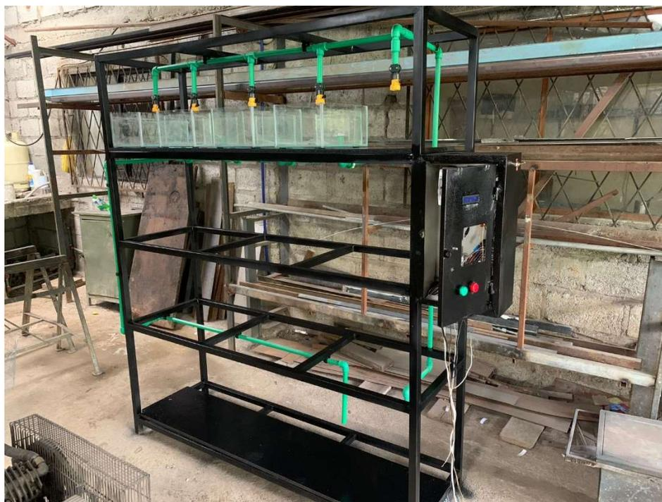
**Nota:** La figura 48 muestra la implementación de la planta superior de la máquina incubadora de anfibios para obtener datos de temperatura, caudal y volumen.
