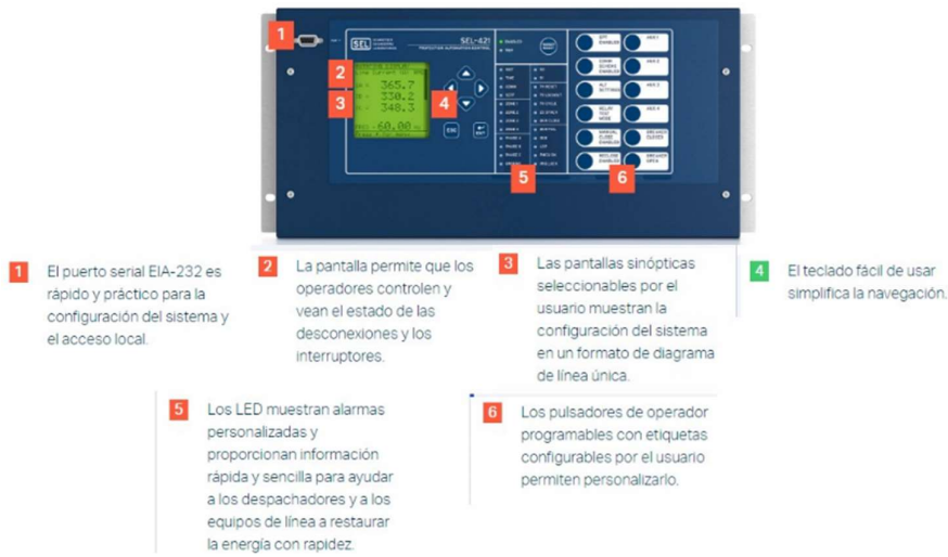
Figura 93. Lado frontal del Relé SEL-421 y Funcionamiento
