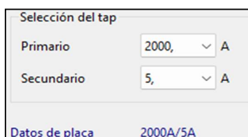
Figura 45. Valores configurados del CT en Digsilent
