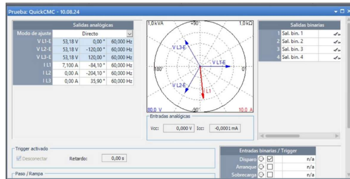
Figura 92. Parámetros de ingreso para la Falla Monofásica a tierra al 100% en el OMIGRON Fuente: Los Autores – Laboratorio de Protecciones
