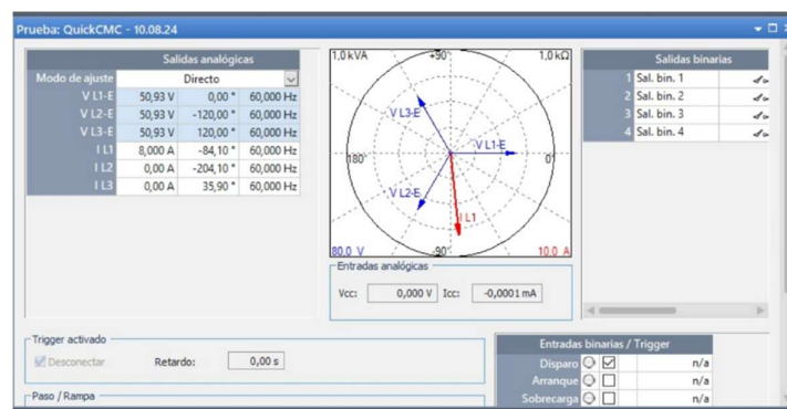
Figura 90. Parámetros de ingreso para la Falla Monofásica a tierra al 85% en el OMIGRON Fuente: Los Autores – Laboratorio de Protecciones
