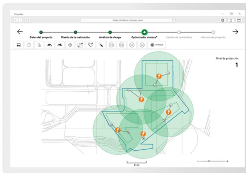
Figura 3. Software para protección atmosférica
