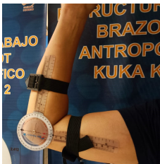
(a) Proceso de medición del ángulo producido por el giro de la cadera.
