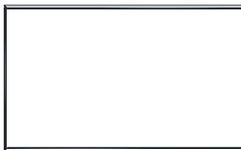
El rectángulo con el eje mayor horizontal se usa para señales de información y guía; señales para obras en las vías y propósitos especiales, así como placas complementarias para señales regulatorias y preventivas
