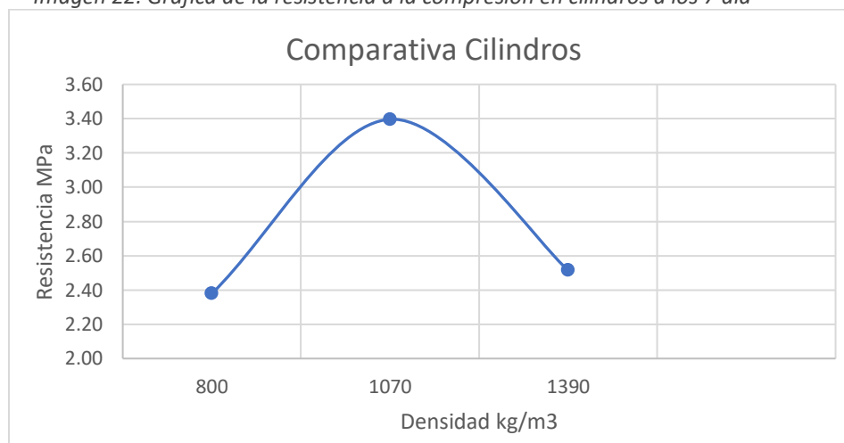
Imagen 22: Grafica de la resistencia a la compresión en cilindros a los 7 día
