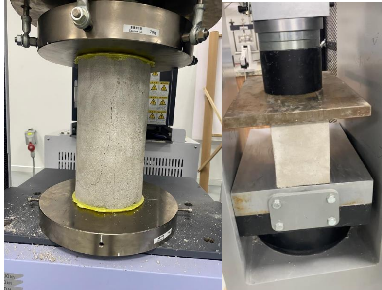
Imagen 21: Ensayo a compresión de las probetas
