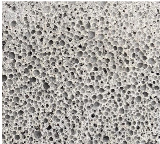
Imagen 3 : Estructura interna del concreto celular
