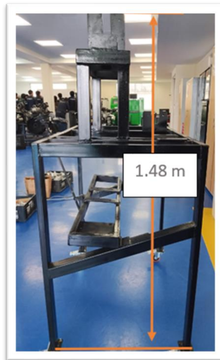
Figura 5.24: Alto de la estructura del banco.
