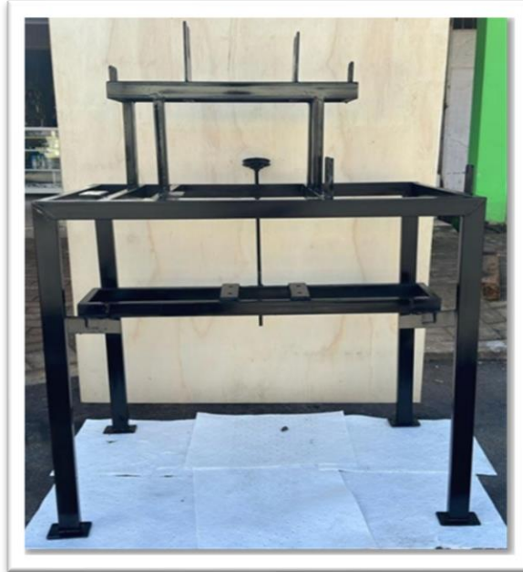
Figura 4.16: Aplicación de pintura poliuretano.
