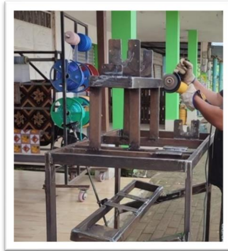
Figura 4.14: Pulir acabados de la soldadura.
