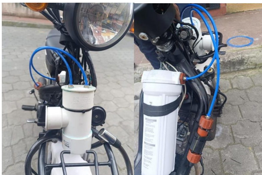
Figura 2.20: Instalación y adaptación de líneas aire.
