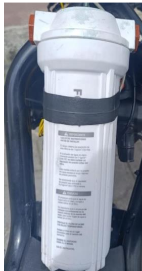
Figura 2.17: Instalación y adaptación de celda de hidrógeno
