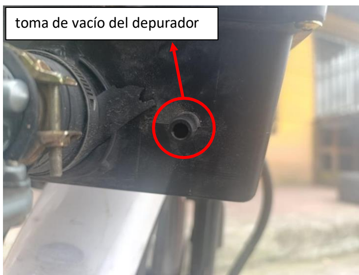
Figura 2.21: Toma de vacío del depurador.
