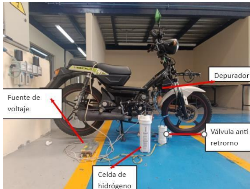
Figura 2.14: Ubicación del sistema generador de hidrógeno
