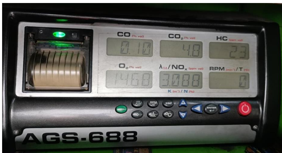
Figura 3.3 Medición de gases combustión de hidrógeno.
