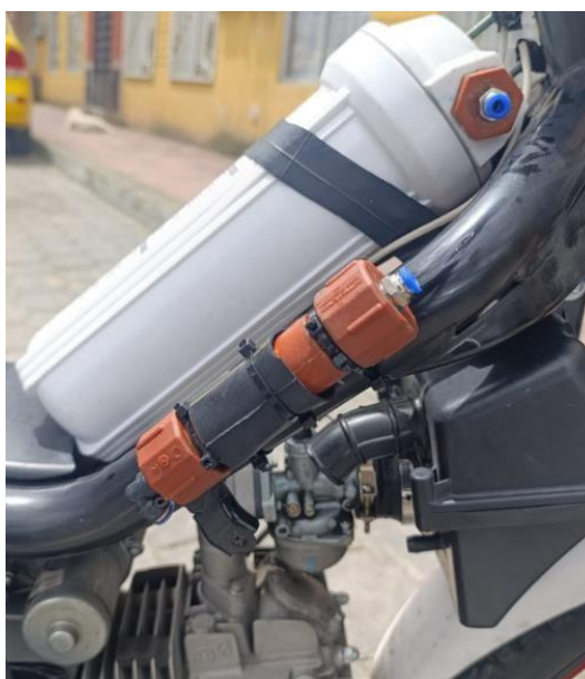
Figura 2.19: Instalación y adaptación de filtro apagallamas.
