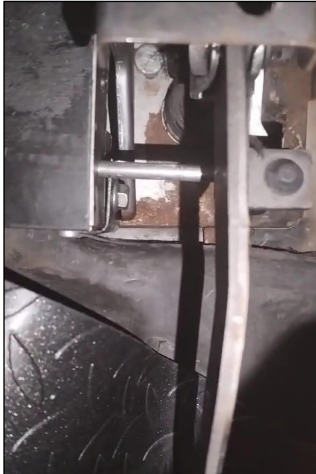
Figura 3.14. Instalación completa del sistema de seguridad discreto
