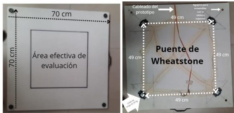
Figura 11. Estructura del tablero del UPSJUMP
