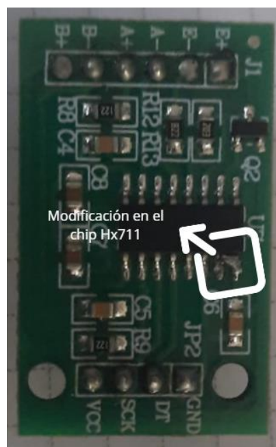
Figura 16. Modificación en el módulo Hx711
