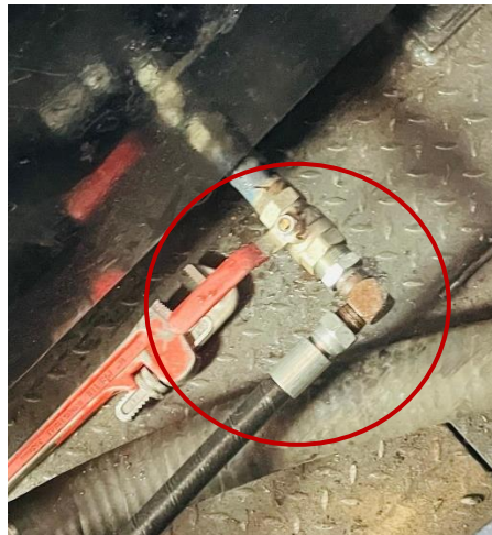
Figura 4.8: Conexión de manguera de succión
