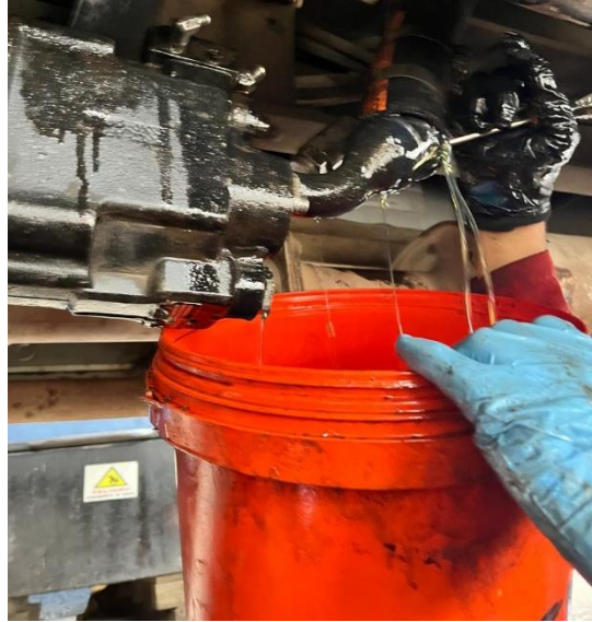
Figura 4.16: Desprendimiento del conducto de caudal.
