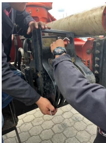
Figura 4.20: Remoción de pernos de sujeción del protector de mandos
