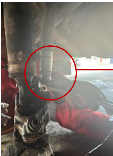
Figura 4.17: Desprendimiento del conducto de presión.
