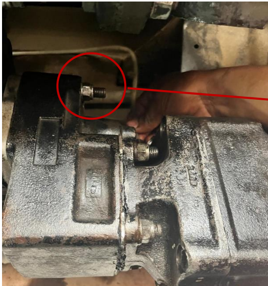
Figura 4.12: Remoción tuercas que sujetan el PTO
