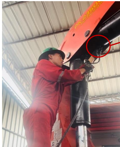
Figura 4.6: Proceso de engrase de la grúa
