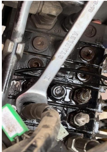
Figura 4.21: Remoción de acople de manguera inferior
