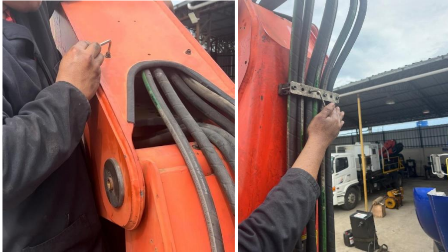
Figura 4.23: Remoción de pernos de sujeción de las mangueras
