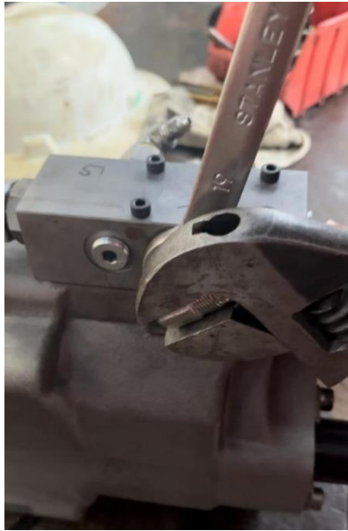
Figura 4.18: Colocación de tapones en la bomba hidráulica.
