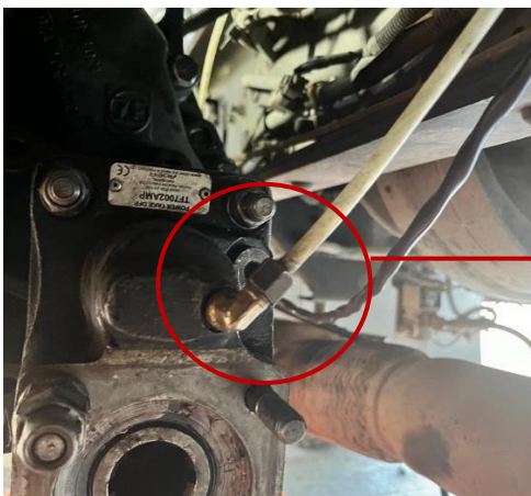
Figura 4.11: Remoción el acople neumático
