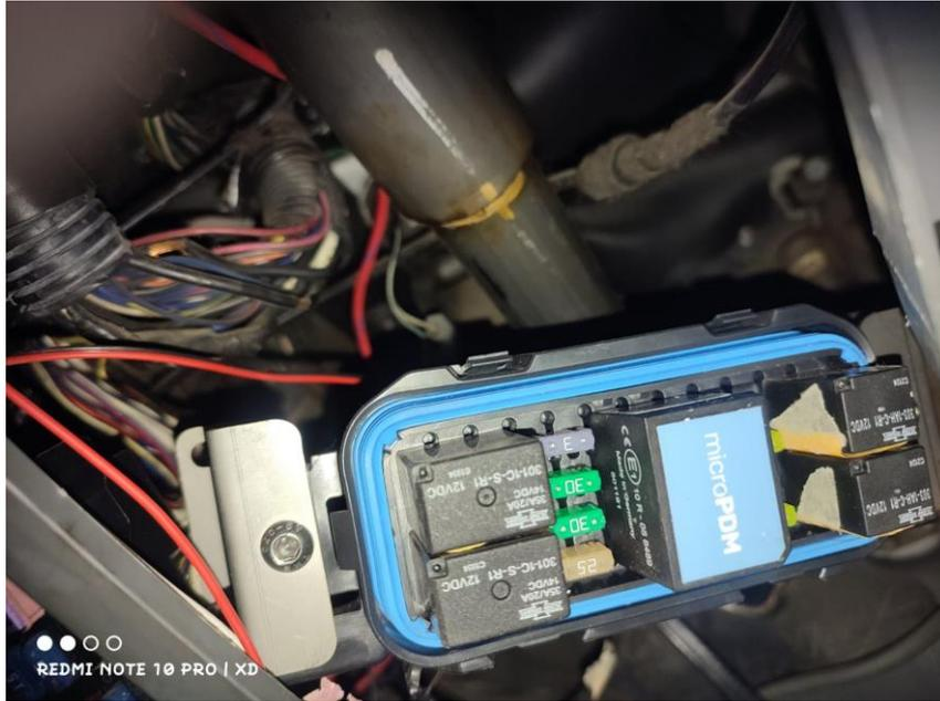
Anexo 9. Fusilera con MicroPDM ubicado bajo el volante sin alguna interrupción al conductor
