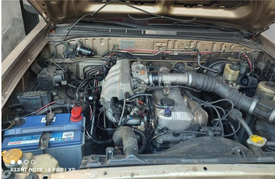
Anexo 7. Conexión de la fusilera al positivo de la batería (cable rojo)
