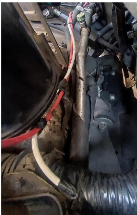
Conexión de batería y arranque, Fuente: Autores
