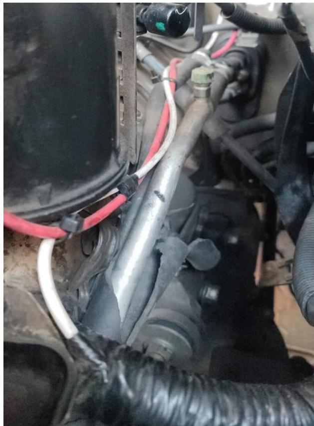
Anexo 8. Conexión de fusiblera a motor de arranque (cable blanco)
